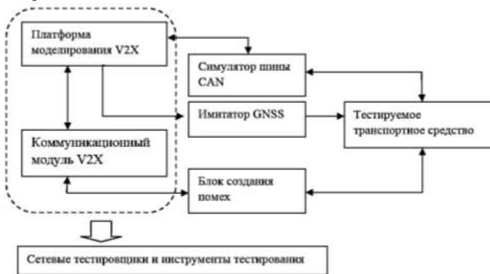
Рисунок 2 - Архитектура тестирования бортовых информационно-управляющих систем транспортного средства
