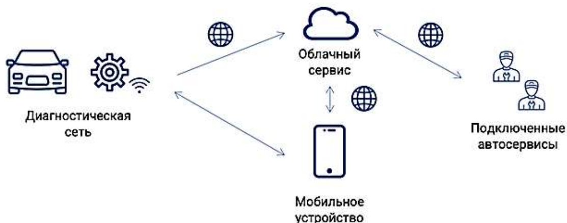
Рисунок 1 – Структурная схема сервиса удаленной диагностики
