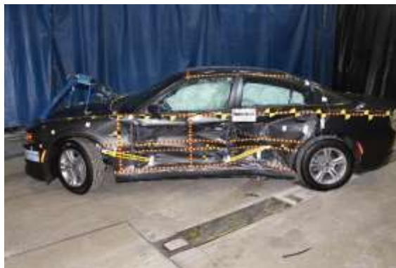
Рисунок 2 – Dodge Charger в результате столкновения с деформирующей силой, распределенной по все площади боковой части кузова
