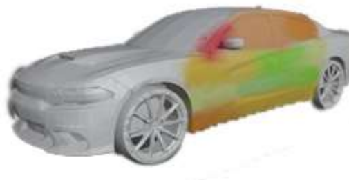
Рисунок 8 – Тепловая карта распределения значений модуля упругости I рода Dodge Charger
