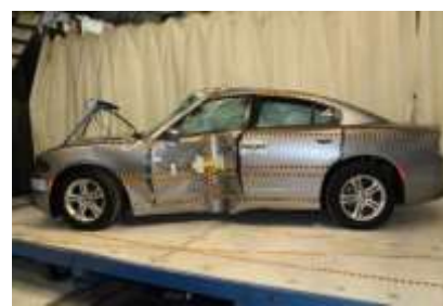
Рисунок 5 – Dodge Charger в результате столкновения с сконцентрированной деформирующей силой
