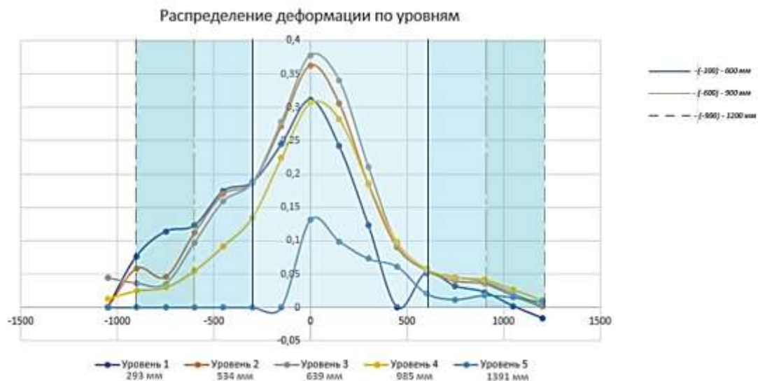
Рисунок 10 – График распределения деформации по боковой части автомобиля
