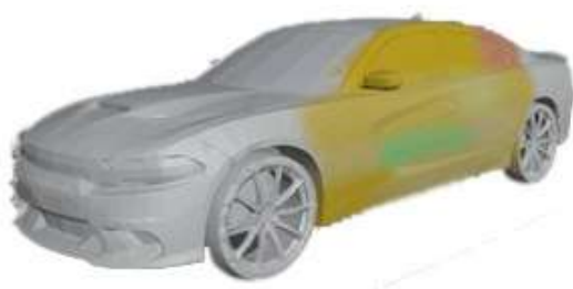
Рисунок 7 – Тепловая карта распределения значений коэффициента Пуаа боковой части кузова Dodge Charger
