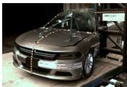
Рисунок 4 – Dodge Charger в момент столкновения со столбом
