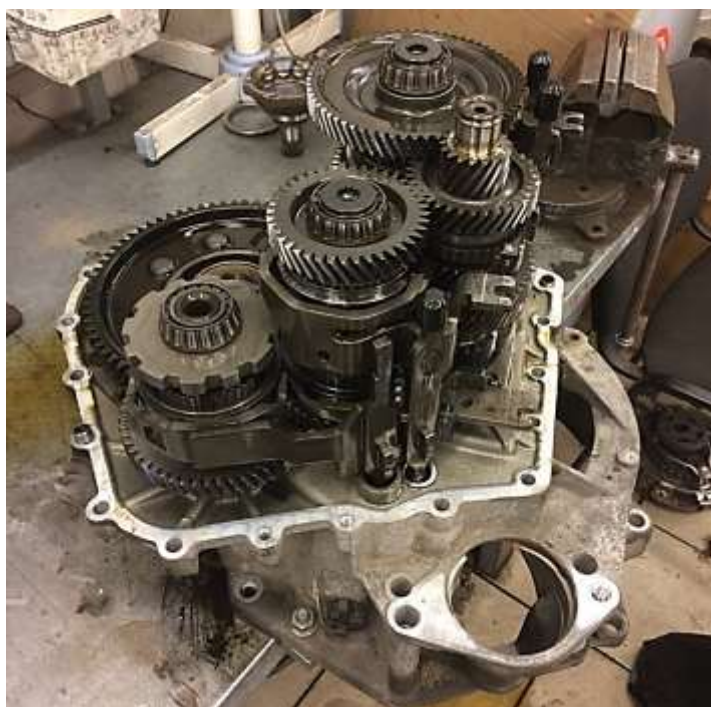
Рисунок 2 – DSG-7 DQ-200 в разобранном состоянии
