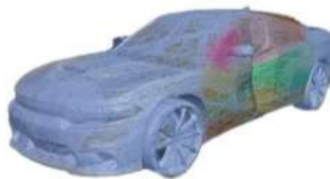
Рисунок 12 – Тепловая карта распределения значений модуля упругости I рода Dodge Charger
