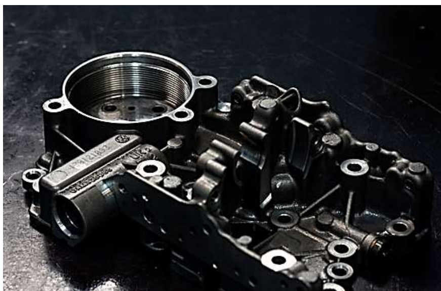
Рисунок 4 – Гидравлическая часть мехатроника
