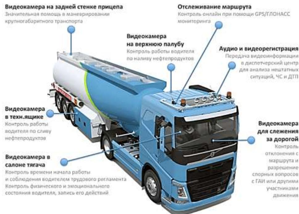
**Рисунок 8 - Пример оснащения седельного тягача с полуприцепом цистерной системой видеонаблюдения**
