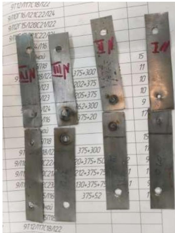
Рисунок 4 – Разрушенные образцы: №1 – электроконтактная сварка; №2 – электрозаклепка; №3 – электрозаклепка; №4 – электроконтактная сварка
