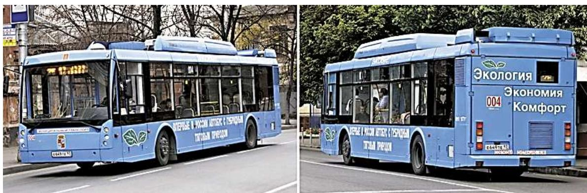
**Рисунок 5 - Опытный образец гибридного автобуса ТролЗА-5250 с турбиной Capstone C65**
