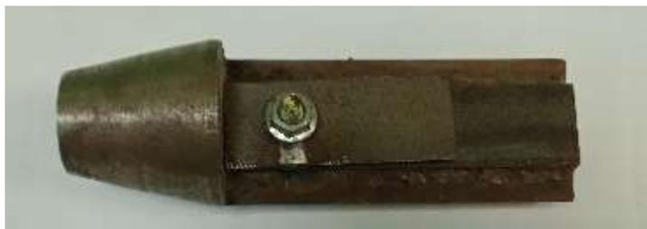
Рисунок 3 – Приспособление для крепления образцов
