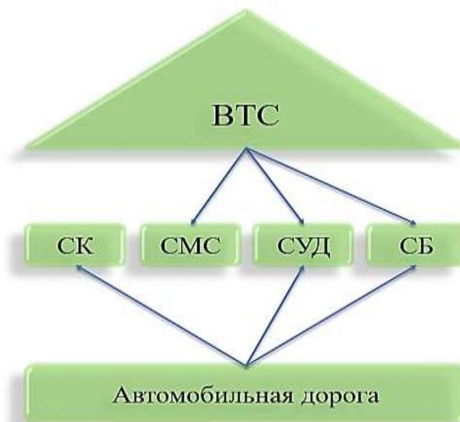
*Рисунок 4 – Информационная модель подсистемы «Автомобильная дорога – высокоавтоматизированное транспортное средство» Высокоавтоматизированное транспортное средство (ВТС), Автомобильная дорога, Система управления движением (СУД), Система безопасности (СБ), Система мониторинга состояния автомобиля (СМС), Система контроля за состоянием дороги и ее ремонтом (СК)*
