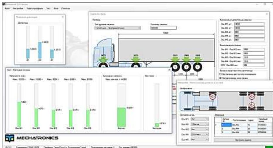
Рисунок 5 - Модель отображения ПО системы датчиков нагрузки на оси ТС
