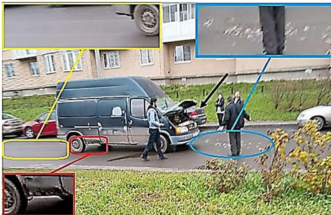
**Рисунок 3 – Фотография с места ДТП. Желтым цветом обозначены следы торможения автомобиля FORD TRANSIT, красным – прерывистая линия разметки 1.5, синим – зона осыпи осколков деталей КТС, черным – конечное расположение автомобиля OPEL ASTRA**
