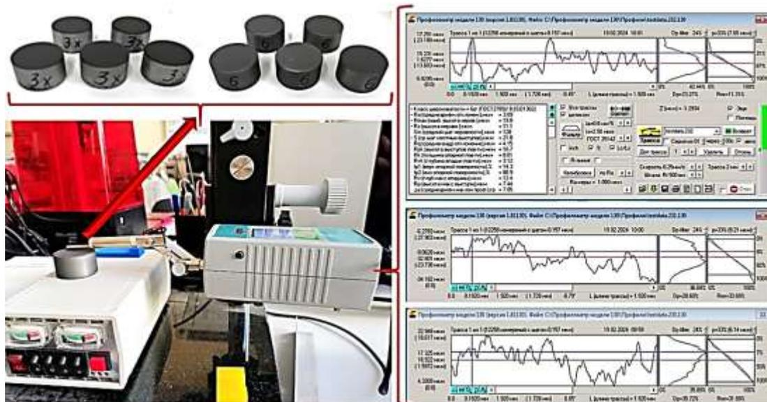
Рисунок 2 – Определение толщины твердосмазочного антифрикционного покрытия
