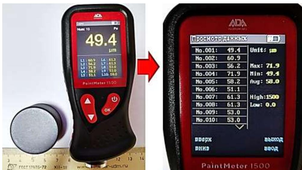
Рисунок 1 – Определение толщины твердосмазочного антифрикционного покрытия
