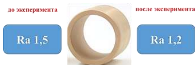
Рисунок 5 – Параметры шероховатости подшипника скольжения (материал – бронза)
