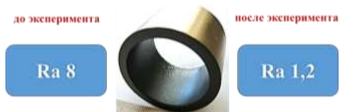
Рисунок 7 – Параметры шероховатости подшипника скольжения (материал – Molykote)
