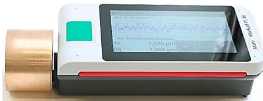
Рисунок 3 – Измерение шероховатости подшипника скольжения на профилометре MarSurf PS10
