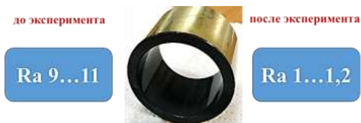
Рисунок 9 – Параметры шероховатости подшипника скольжения (материал – MODENGY)
