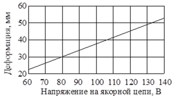
Рисунок 7 – График зависимости деформации грудной клетки от напряжения на якорной цепи
