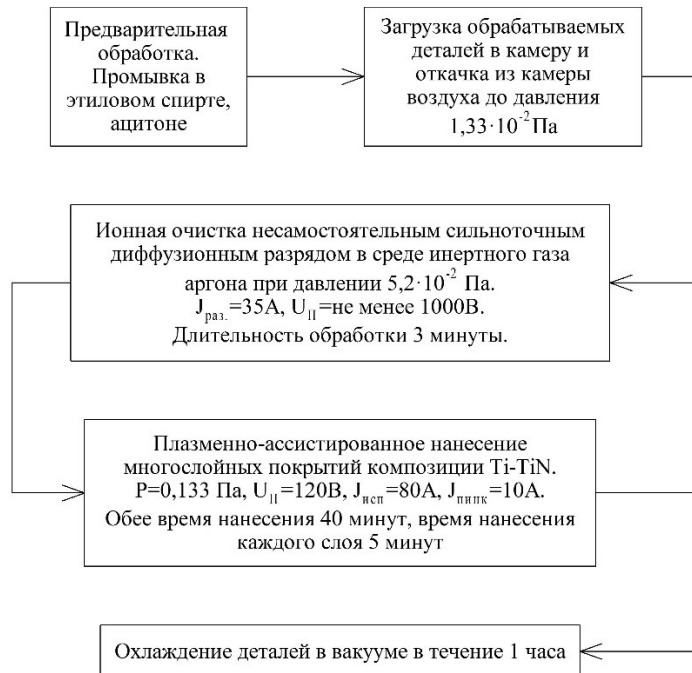
Рисунок 10 – Схема технологического процесса по плазменному ассистированному напылению многоуровневых покрытий системы Ti-TiN
