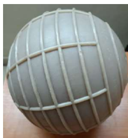
Рисунок 1 – Внешний вид глубоководного сферического модуля Ø 310 мм
