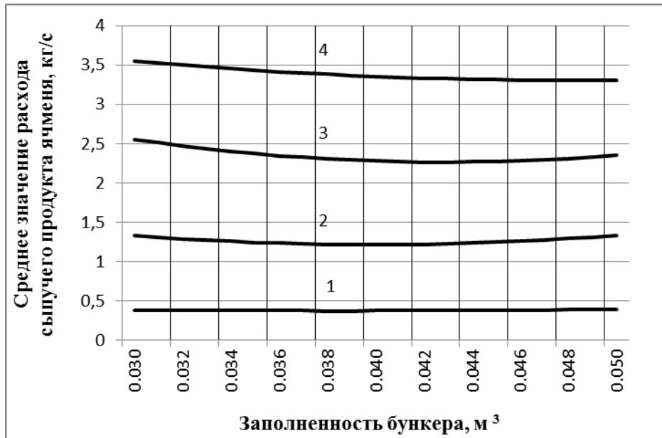
Рисунок 2 – Зависимость средних значений расхода сыпучего продукта от его объема в бункере при площади выпускных отверстий бункера: 1 – 0,002м 2 ; 2 – 0,004 м 2 ; 3 – 0,006 м 2 ; 4 – 0,008 м 2
