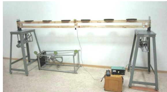
Рисунок 5 – Установка для испытания балок на динамическую нагрузку с тремя нагелями и пятью прокладками
