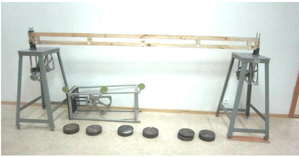
Рисунок 4 – Установка для испытания на статическую нагрузку составной балки с пятью нагелями и пятью прокладками
