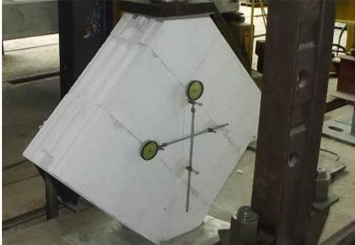
*Рисунок 4 - Испытание на диагональное сжатие*
