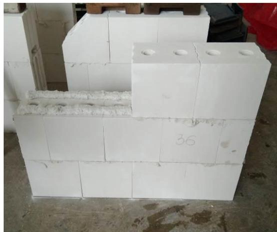
Рисунок 2 - Изготовление опытных образцов каменной кладки
