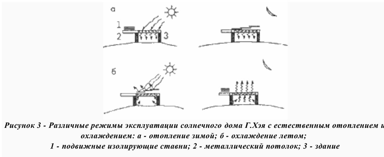
**Рисунок 3 - Различные режимы эксплуатации солнечного дома Г.Хэя с естественным отоплением и охлаждением: а - отопление зимой; б - охлаждение летом; 1 - подвижные изолирующие ставни; 2 - металлический потолок; 3 - здание**
