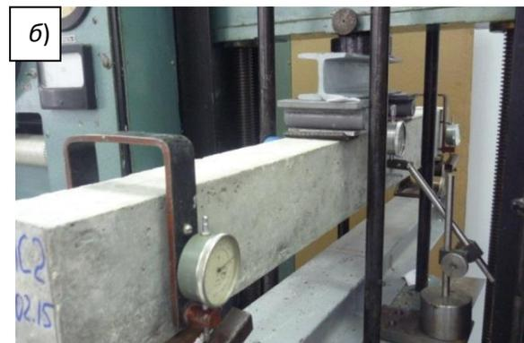
Рисунок 2 - Схема опирания и нагружения (а) и общий вид образцов балок при испытаниях (б)
