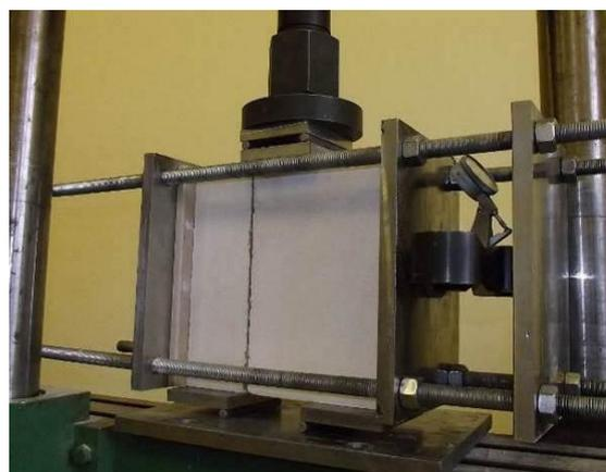
1 – испытываемый образец кладки, 2 – динамометр для контроля уровня обжатия, 3 – передаточные пластины для передачи обжатия, 4 – пластины с роликовыми опорами, 5 – гипсовая прокладка
