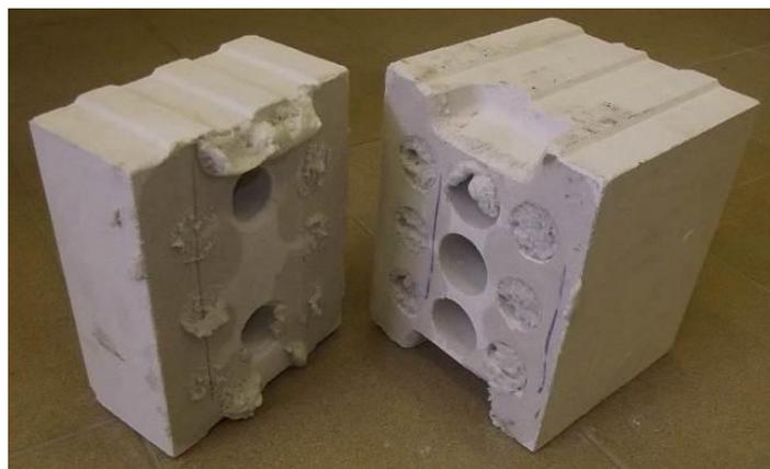
*Рисунок 5 - Характер разрушения образцов кладки при сдвиге в плоскости горизонтальных швов на полиуретановой клей-пене*
