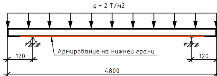
*Рисунок 3 - Расчетная схема испытаний*
