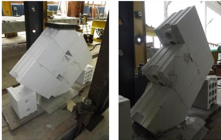
Рисунок 6 - Характер разрушения образцов кладки при диагональном сжатии на полиуретановой клей-пене
