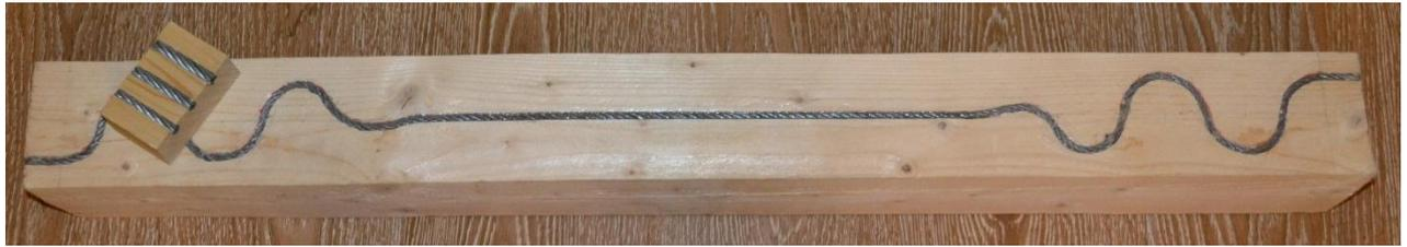
*Рисунок 2 - Демонстрационные образцы армирования по криволинейной траектории*
