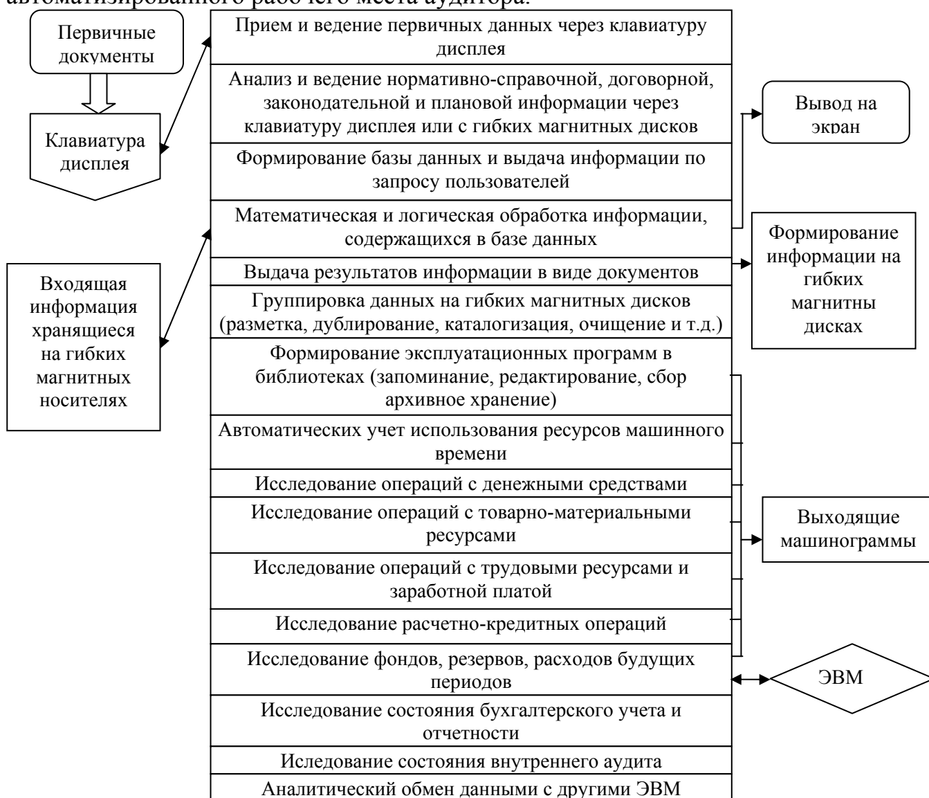
Рисунок 2 - Процесс обработки протекающих в отдельных функциональных цепях персональных, мини-, микро-ЭВМ экономической информации
