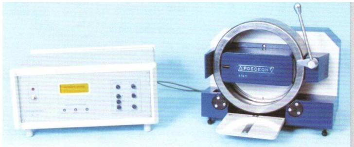
Рисунок 3 – Прибор полуавтоматический для контроля и сортировки наружных колец подшипников по внутреннему диаметру и ширине дорожки качения 4161
