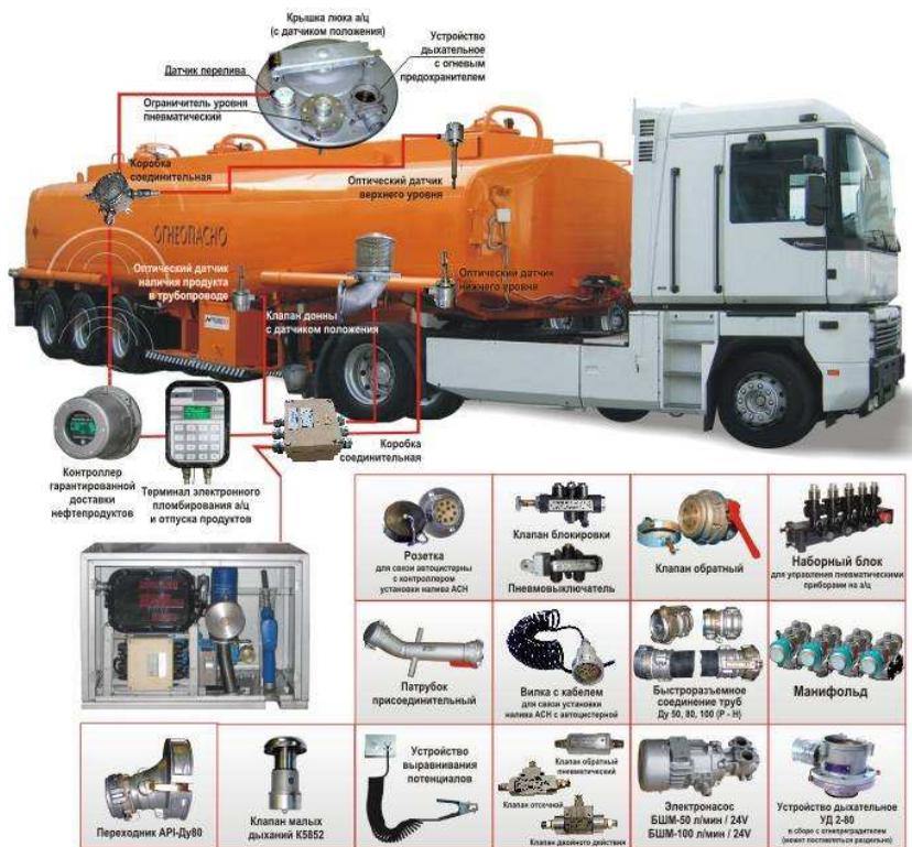
Рисунок 1 – Оснащение автоцистерны оборудованием и вспомогательными устройствами для контроля и осуществления верхнего и нижнего налива.
