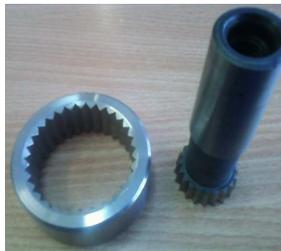
Рисунок 4 – Спрофилированный инструмент и изготавливаемое изделие
