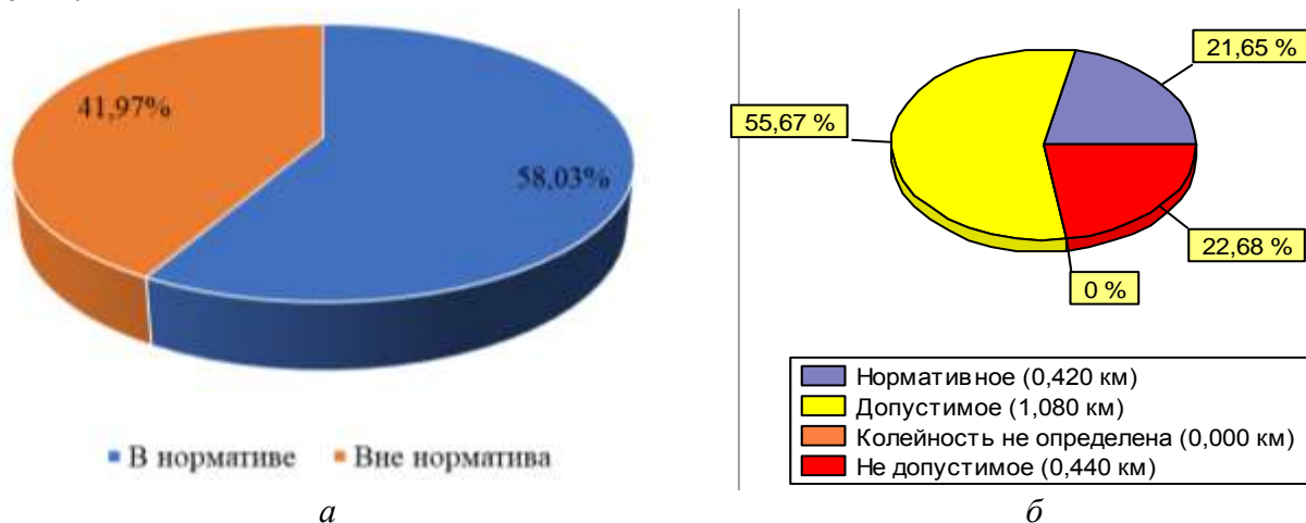
Рисунок 4 – ул. Перспективная – ул. Энергетиков, соответствие продольной (а) и поперечной (б) ровности нормативным значениям
