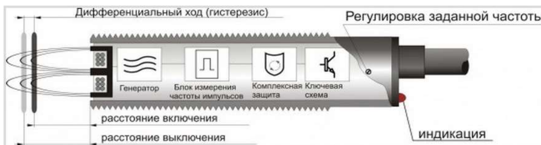
Рисунок 4 – Принцип действия индукционного датчика
