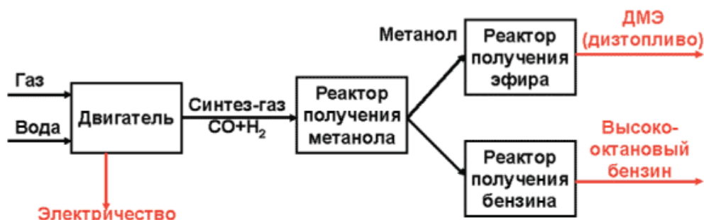
Рисунок 5 – Получение и применение синтез-газа при переработке попутного нефтяного газа
