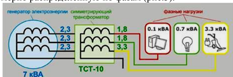
Рисунок 3 - Подключение той же нагрузки к генератору меньшей мощности с использованием ТСТ
