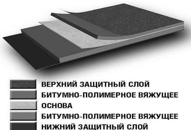
Рисунок 1 – Строение рулонного кровельного материала
