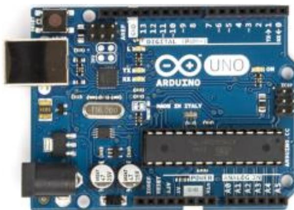
Рисунок 1 – Платформа Arduino UNO
