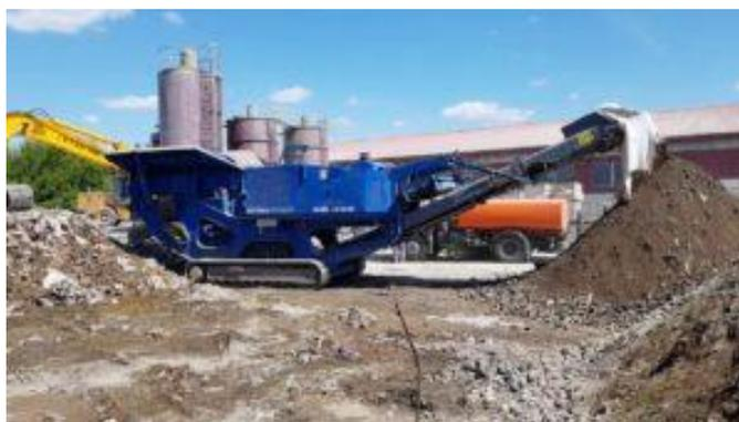
Рисунок 1 – Вторичная переработка отходов строительства и сноса
