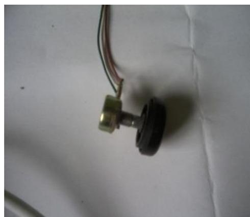
Рисунок 5. Регулятор частоты
