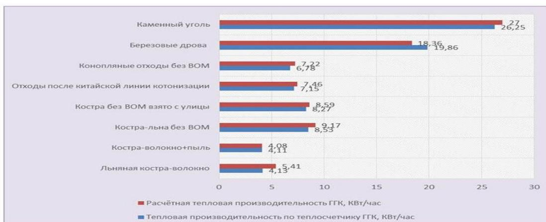
Рисунок 5 – График показателей тепловой производительности альтернативных видов твердых топлив
