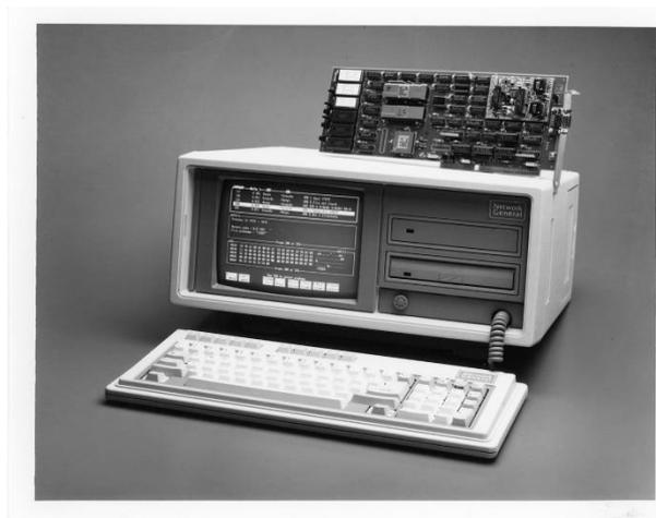
Рисунок 1 – Compaq Portable II с сетевой картой
