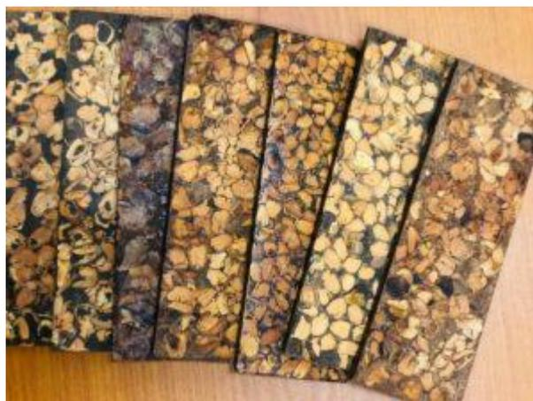
Рисунок 3 – Облицовочные панели из древесных отходов
