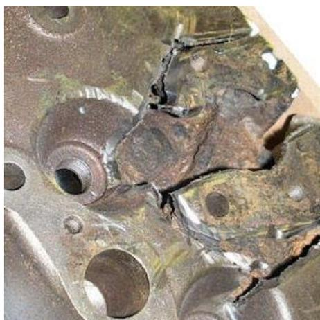
Рисунок 1 – Подготовка деталей под сварку
