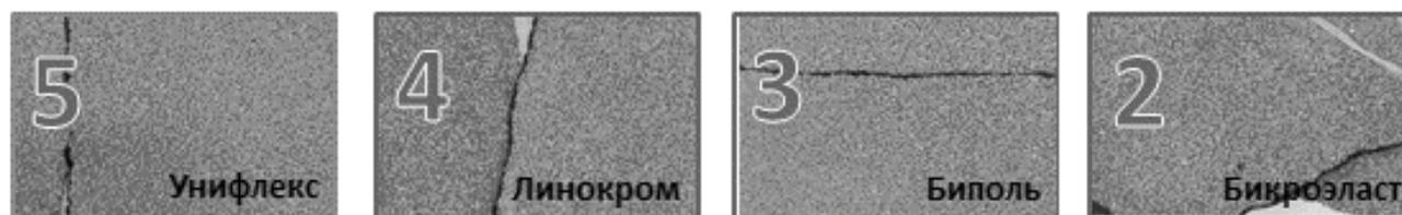
Рисунок 3 – Экспериментальное исследование материала на разрыв
