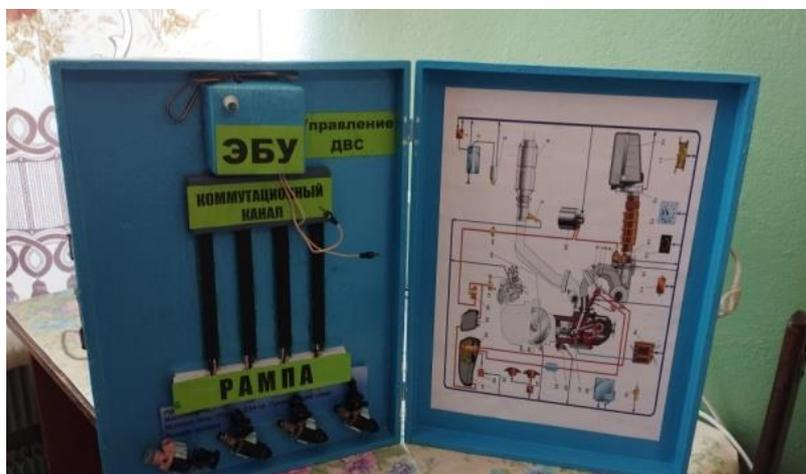
Рисунок 1– Макет инжекторного двигателя
