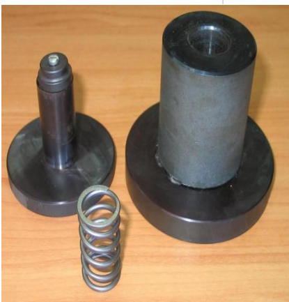
Рисунок 9 – Устройство для заневоливания внутренней пружины клапана двигателя автомобилей ВАЗ (справа: устройство с пружиной и динамометром между захватами разрывной машины)
