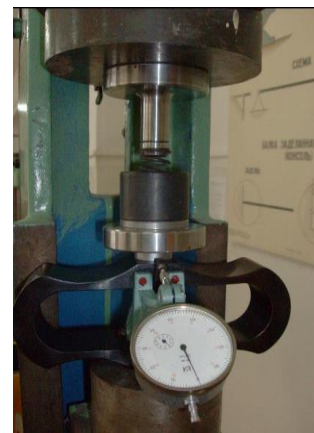
Рисунок 9 – Устройство для заневоливания внутренней пружины клапана двигателя автомобилей ВАЗ (справа: устройство с пружиной и динамометром между захватами разрывной машины)
