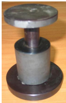
Рисунок 9 – Устройство для заневоливания внутренней пружины клапана двигателя автомобилей ВАЗ (справа: устройство с пружиной и динамометром между захватами разрывной машины)
