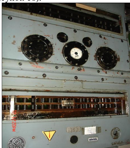
Рисунок 10 – Стенд резонансного типа DV8-S2 ф.«Gejrg Reicherter»
