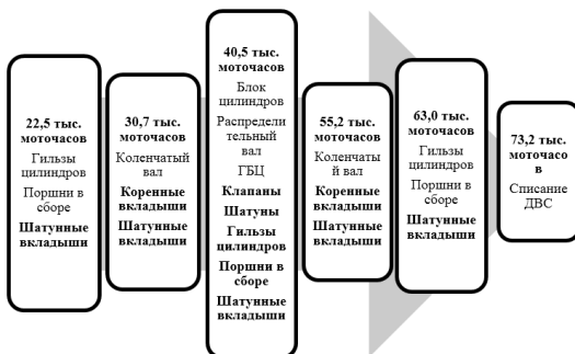
Рисунок 4 – Структура групповой замены деталей двигателя MTUDD16V4000 карьерного самосвала БЕЛАЗ-75309
