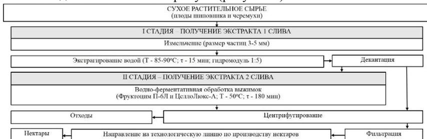
Рисунок 5 – Технологическая схема переработки сухих плодов
