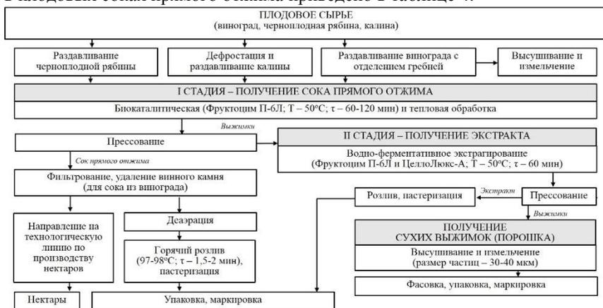
Рисунок 4 – Технологическая схема переработки плодового сырья
