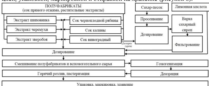
Рисунок 6 – Технологическая схема производства нектаров
