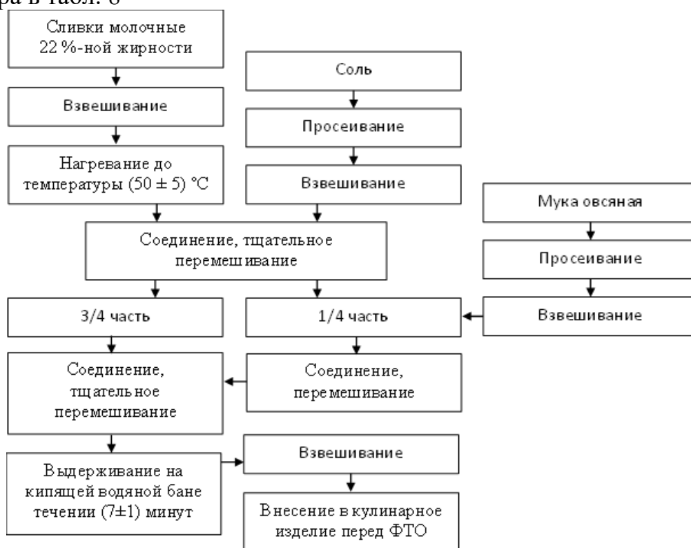
Рисунок 8. Технологическая схема изготовления сливочного соуса (усовершенствованная)
