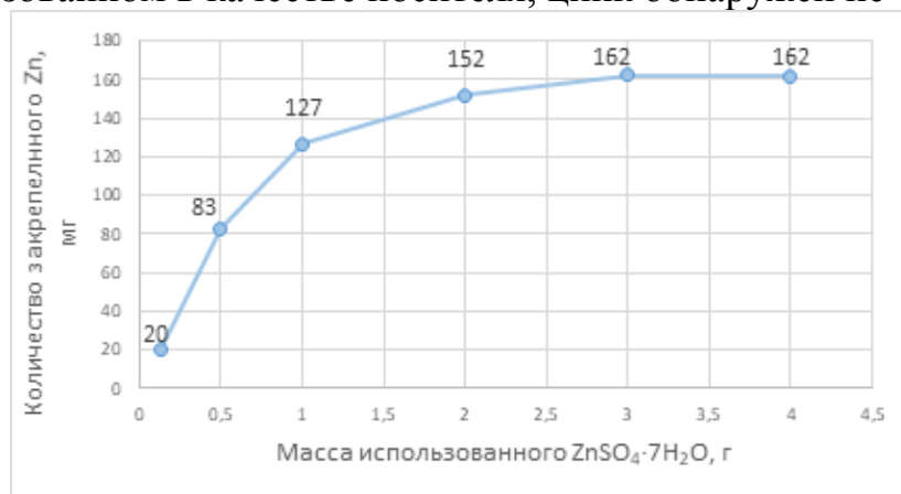
Рисунок 2 – Максимальный объем сорбции цинка в форме \text{ZnSO}_4 \cdot 7\text{H}_2\text{O} на поверхности 1 г хитозана
