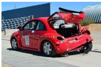
Рисунок 2 – Пример деформаций ТС после тестов, примеры из тестов №8676 и № 8678
