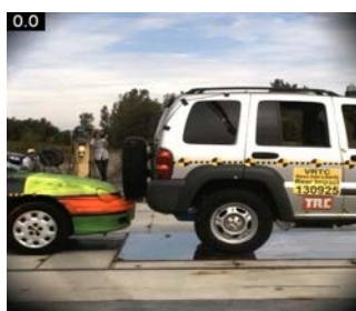
Рисунок 4 – Тест №8547, слева - момент начала КСВ (время 0,0 мс), справа – момент завершения КСВ (время 104,0 мс)
