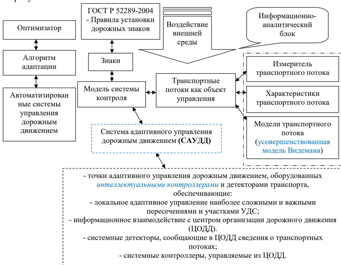
Рисунок 1 – Предлагаемая структурно-функциональная схема управления дорожным движением крупного города
