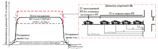
Рисунок 10 – Интерпретация процесса движения с учетом динамических показателей калиброванного автомобиля
