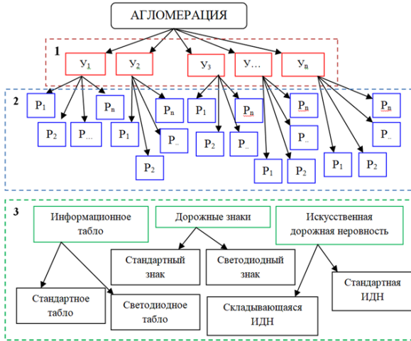
Рисунок 17 – Схема СУСДТП: 1 – исходные данные (условия); 2 – причины, воздействующие на водителя и его ТС; 3 – технические средства ОДД, применяемые для повышения БДД
