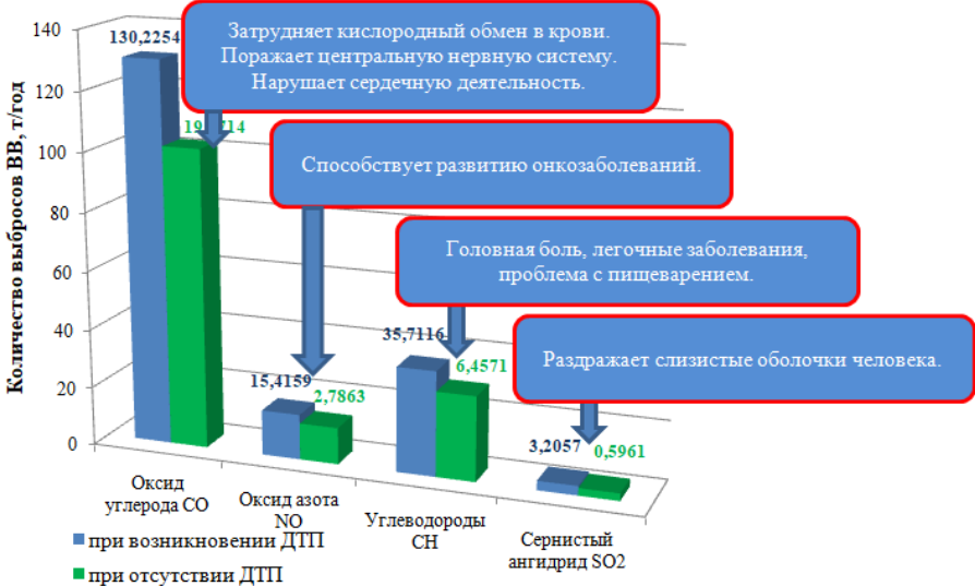
Рисунок 22 – Значения выбросов вредных веществ (ВВ) при возникновении и отсутствии ДТП
