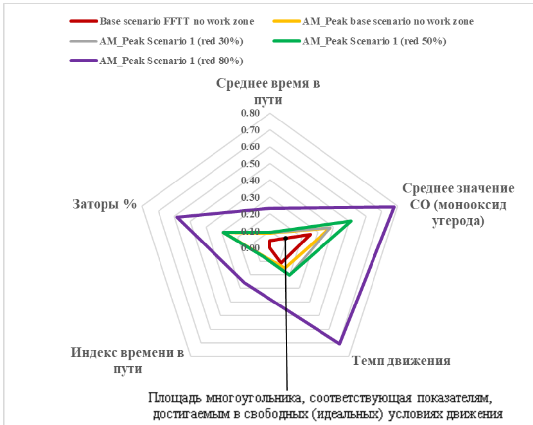
Рисунок 9 – Диаграмма интегральной эффективности ОДД для различных сценариев моделирования
