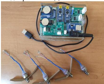
Рисунок 3 – Информационно-аппаратная система сбора данных
