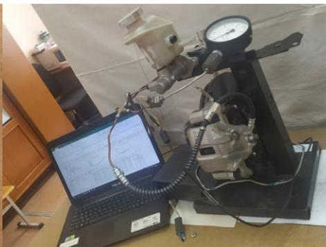
Рисунок 4 – Отладочный тормозной стенд
