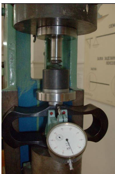
Рисунок 3.9 — Устройство с пружиной и динамометром между захватами разрывной машины [88]
