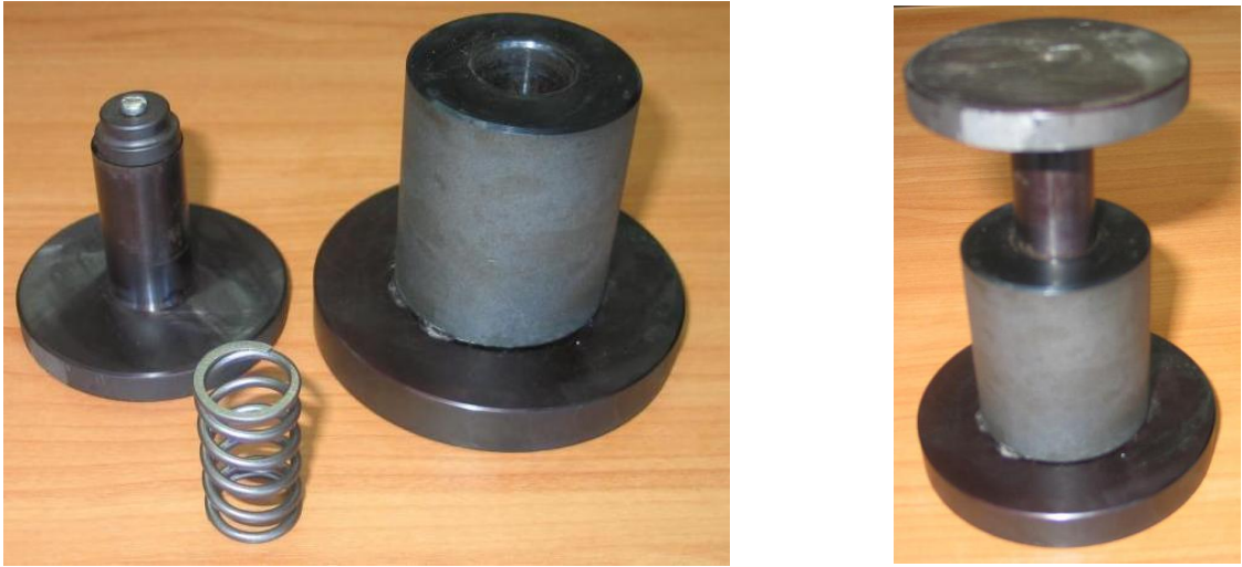
Рисунок 3.7 — Устройство для заневоливания внутренней пружины клапана двигателя автомобилей семейства ВАЗ [88]
