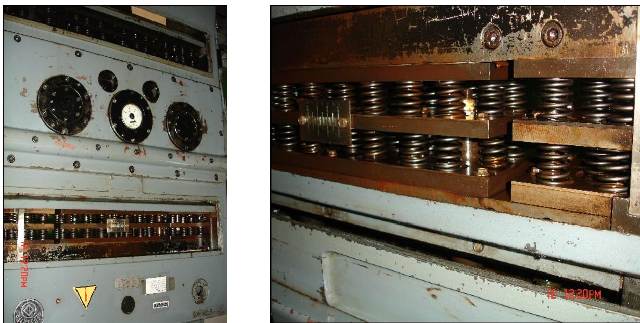
Рисунок 3.10 — Стенд резонансного типа DV8-S2 ф.«Gejrg Reicherter»
