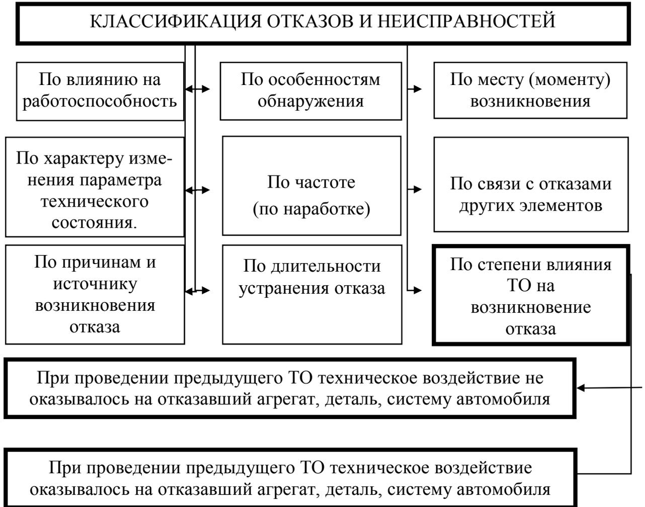
Рис. 2.4. Определение основного классификационного признака отказов и неисправностей для построения модели влияния периодичности ТО на отказ
