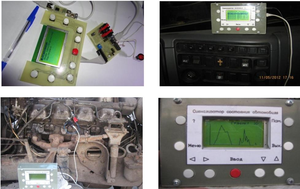
Рисунок 7 – Встроенная система диагностирования
