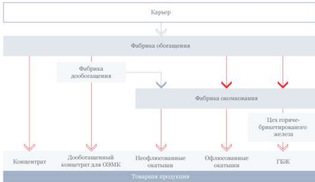
Рисунок 1.5 - Технологический процесс производства Лебединского ГОКа
