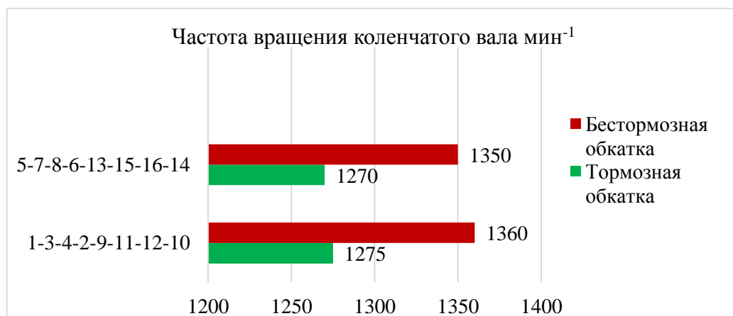
Рисунок 4.12 – Частота вращения коленчатого вала двигателя при работе одной половины цилиндров, \text{мин}^{-1}
