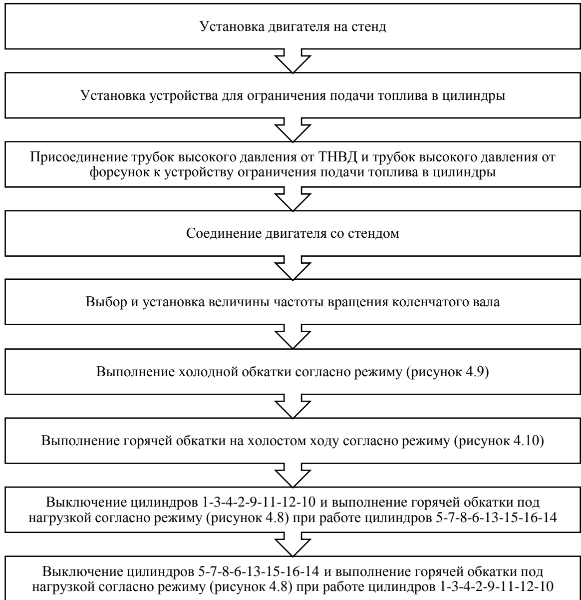
Рисунок 4.11 - Алгоритм проверки эффективности обкатки двигателя при бестормозном способе
