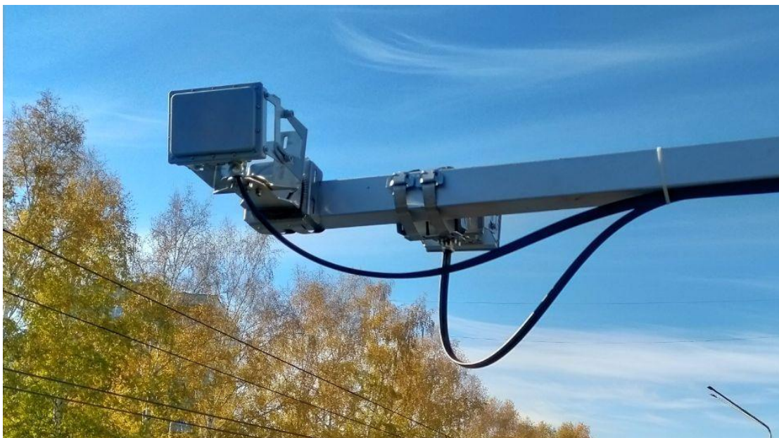
Рисунок 60 - Стационарный многолучевой радарный ДТ «Смартроад TMS.13-T25» (фото производителя «Sorб - Engineering», РФ)
