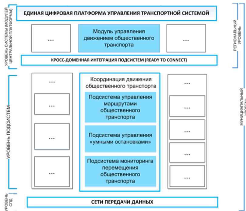
Рисунок 16 – Архитектура модуля управления движением общественного транспорта
