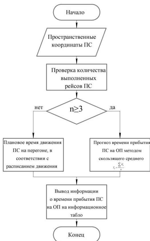
Рисунок 42 – Алгоритм формирования и вывода информации о времени прибытия ГПТОП на ОП маршрута (в соответствии с ПНСТ 892-2023) [87]
