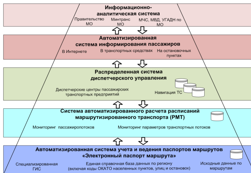
Рисунок 11 – Структура и взаимодействие основных компонентов диспетчерского управления, безопасности и информирования на ГПТОП
