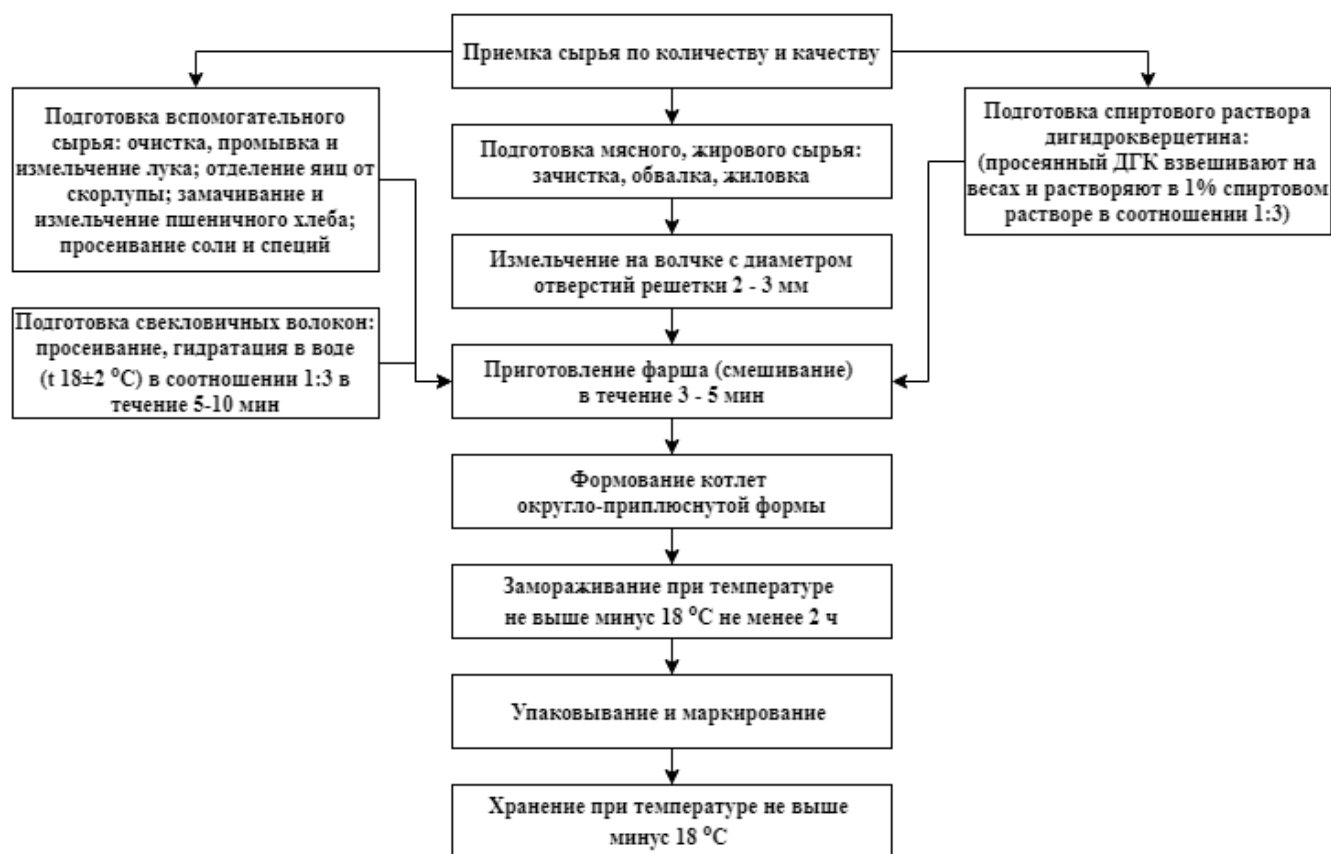
Рисунок 4.8 - Технологическая схема производства котлет «Лосиные особые»
