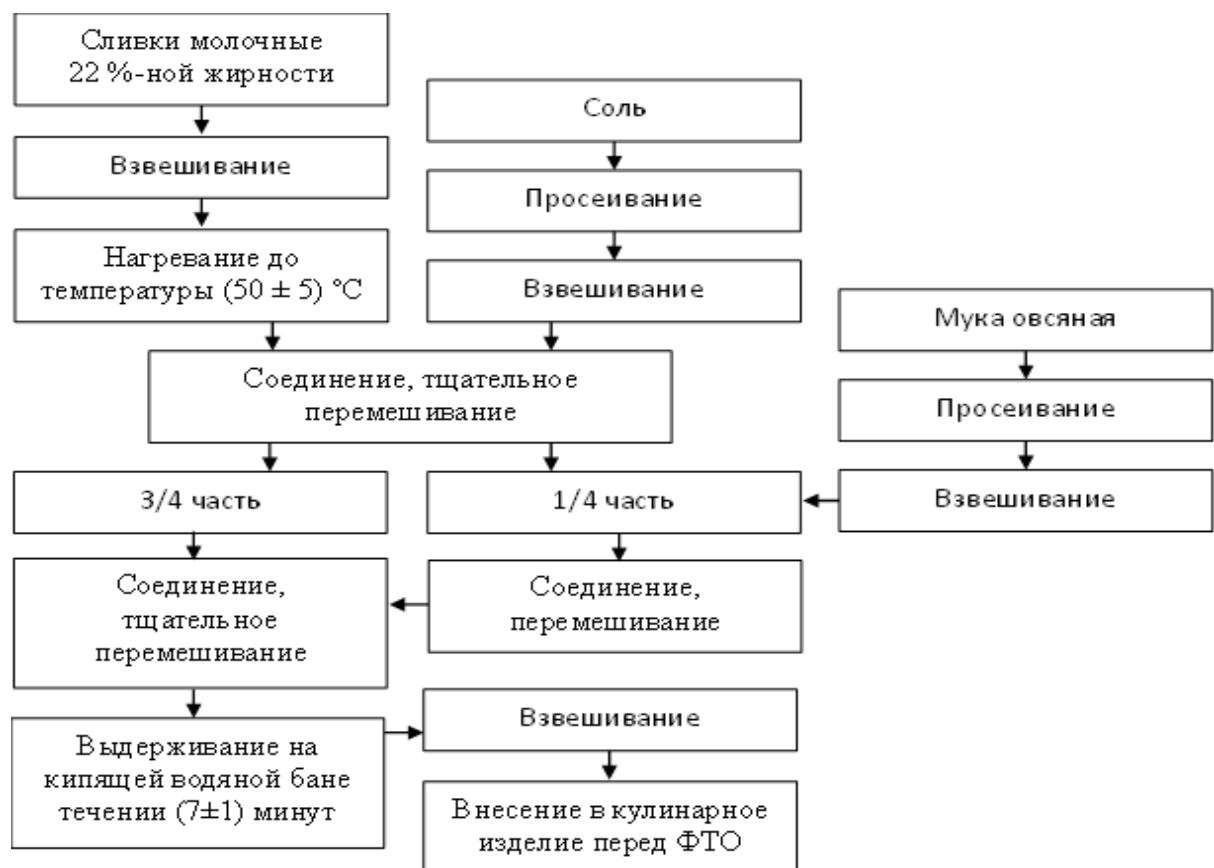
Рисунок 22 – Технологическая схема изготовления сливочного соуса (усовершенствованная)
