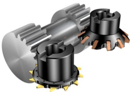
Рисунок 1.7 - Модель обработки блока зубчатых колес по технологии InvoMilling
