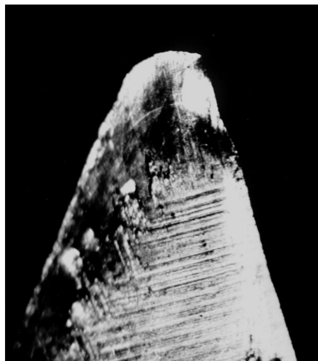
Рисунок 1.13 – Изношенный зуборезный резец для обработки конического зубчатого колеса [21]
