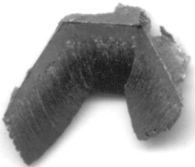
Рисунок 1.11 – Вид стружки, срезаемой зуборезным долбяком
