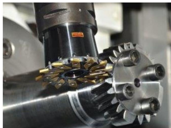
Рисунок 1.8 - Обработка зубчатого колеса по технологии InvoMilling
