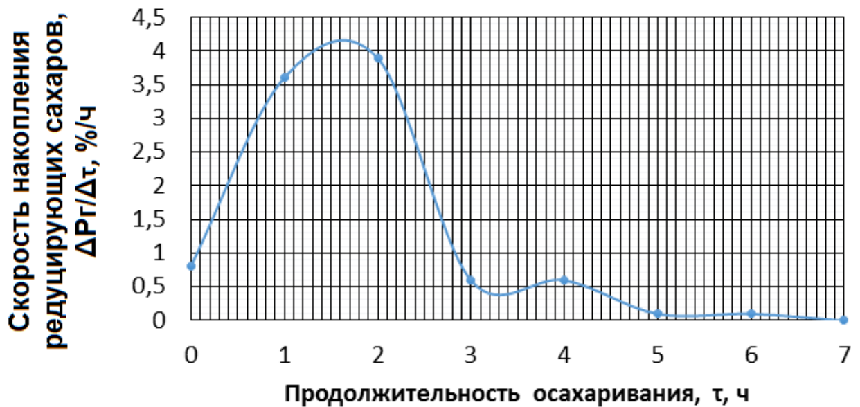
Рисунок 3.6 – Дифференциальная кривая ферментативного процесса гидролиза картофельной массы
