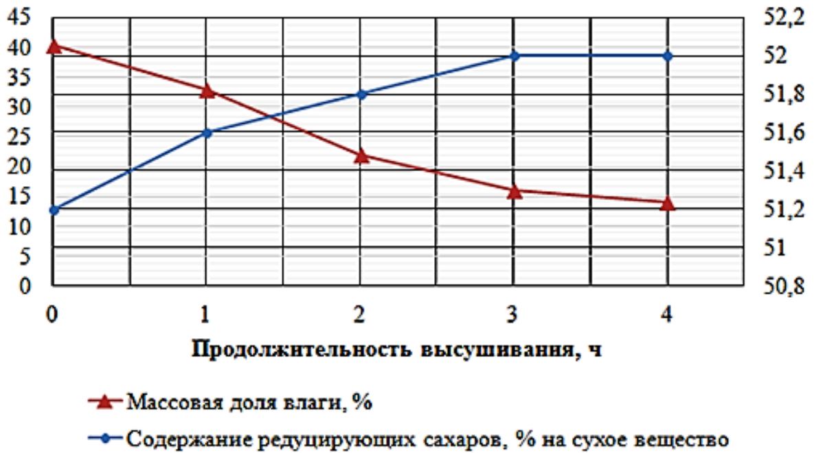
Рисунок 3.11 – Влияние продолжительности высушивания на массовую долю влаги и содержание редуцирующих сахаров в пасте гидролизата картофельной массы, смешанной с СПК
