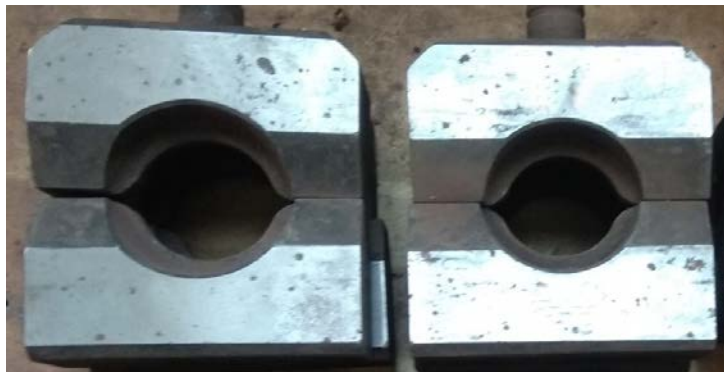
Рисунок 4.9 – Комплекты изготовленных бойков с гиперболическим профилем заходного конуса (слева) и базового исполнения (справа)
