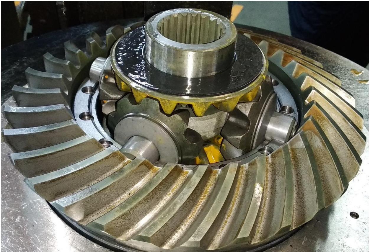
Рисунок 50 – Межколесный дифференциала, укомплектованный полуосевыми шестернями и сателлитами
