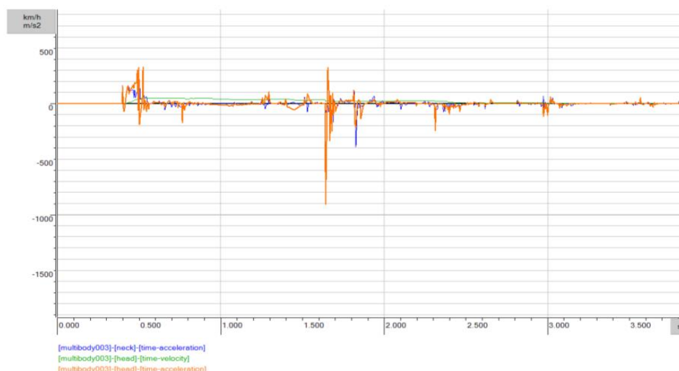
Рисунок 3.12 - Пример графика изменения скорости и замедлений/ускорений на ЦТ головы и шее манекена для случая Н, кластер 3, угол 25, площадь 0,8 м 2 , высота 0,7 м, скорость 70 км/ч
