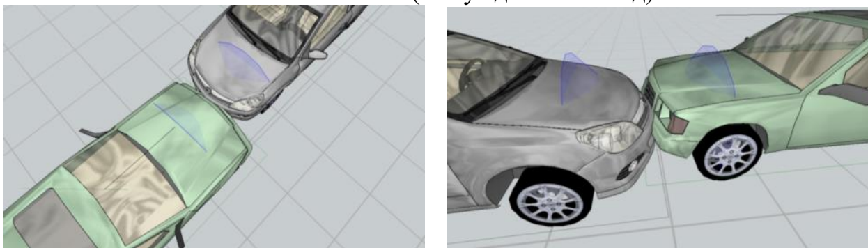
Рисунок 4.16в - Финальный контакт. Масштабное наложение очагов повреждений а/м марки Мерседес Бенц S500 на очаг повреждений а/м марки Опель Астра с учетом фотографического материала представленного на исследование
