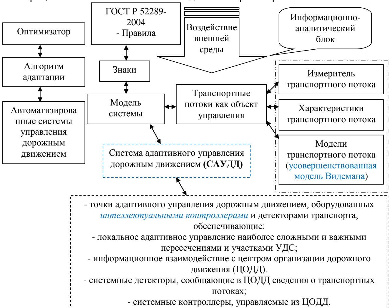
Рисунок 3 – Предлагаемая структурно-функциональная схема управления дорожным движением крупного города
