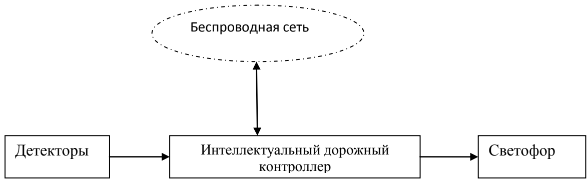
Рисунок 7 – Структура АСУДД третьего поколения
