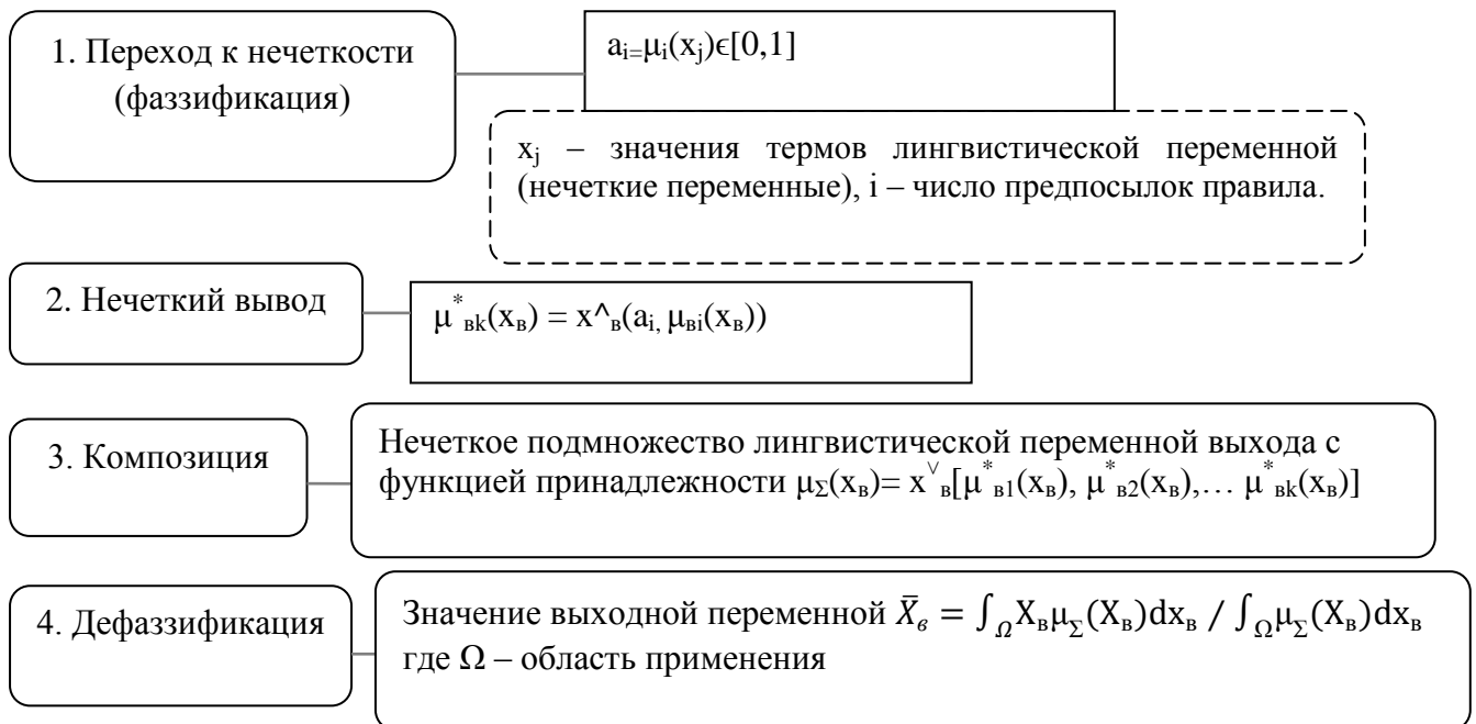
Рисунок 29 – Схема реализации работы системы нечеткого вывода (СНВ)
