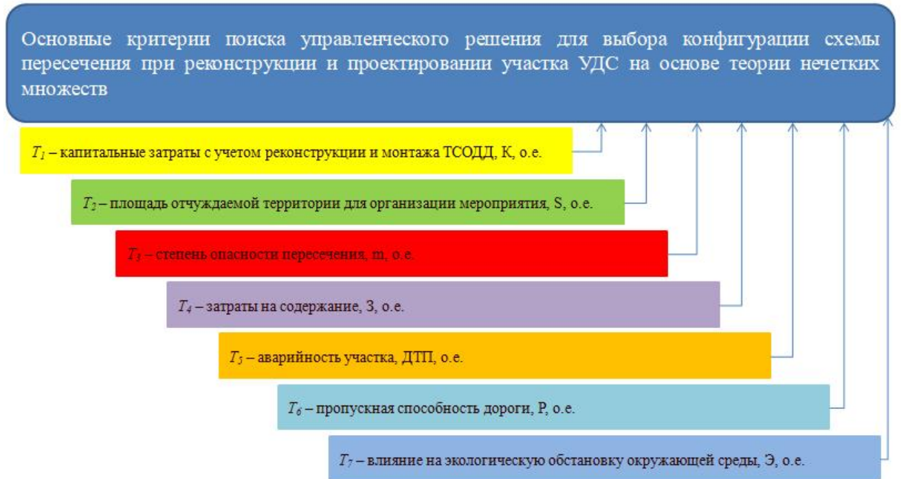
Рисунок 83 – Критерии поиска управленческого решения для создания математической модели выбора рационального варианта схемы пересечения на УДС
