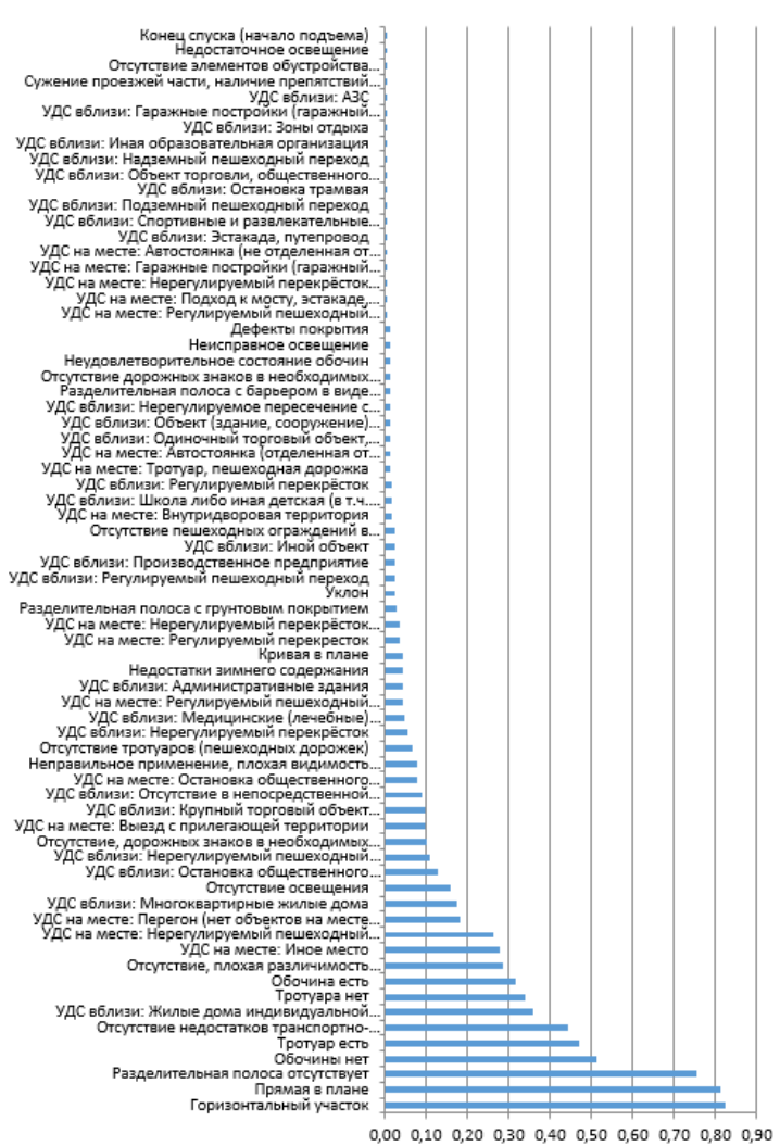
Рисунок 1.27 – Процентное распределение частоты встречаемых факторов в ДТП с наездом на пешехода в населенном пункте
