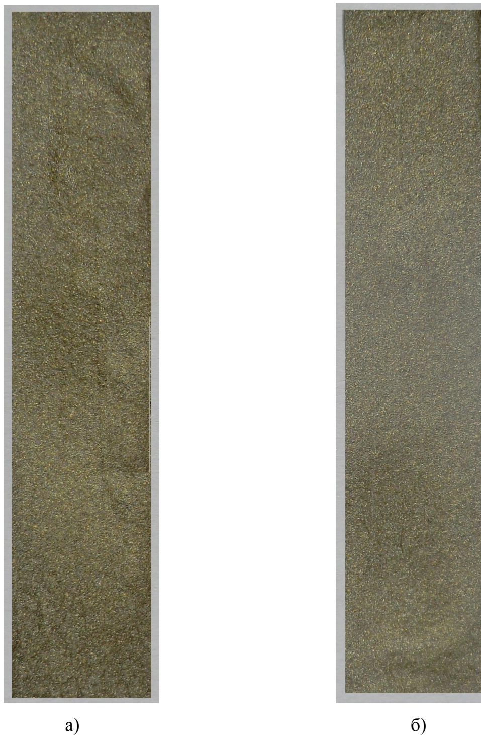
Рисунок 4.20 – Пленки из композиции эластомера Ф-40 без УЗО а), после УЗО б)
