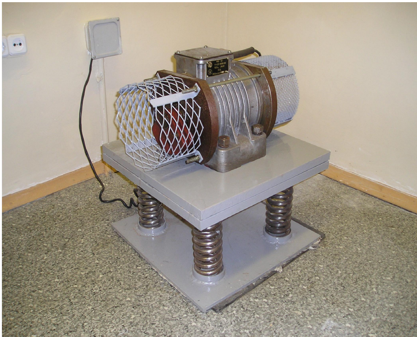
Рисунок 3.12 – Стенд для исследования долговечности при циклическом нагружении посадок подшипников на базе электро-механического вибратора ИВ-107А
