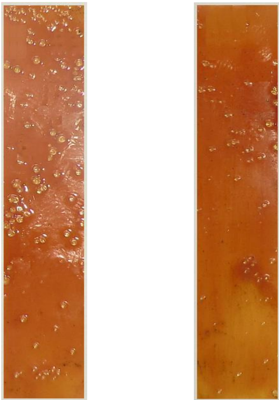
Рисунок 4.19 – Пленки из эластомера Ф-40 без УЗО а), после УЗО б)
