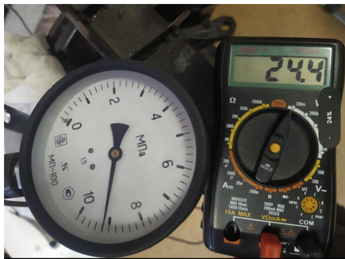
Рисунок 3.18 – Оценка давления тормозной жидкости с помощью мультиметра.
