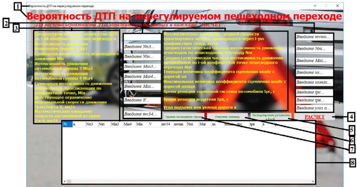
Рисунок 4.3 – Интерфейс программы расчёта риска ДТП на нерегулируемом пешеходном переходе: 1 – Название программы; 2 – пояснение к используемым в программе параметрам дорожного движения; 3 – поля ввода параметров дорожного движения с пояснениями; 4 – кнопка расчёта вероятности ДТП; 5 – кнопка отображения результатов расчёта в программе MSExcel; 6 – кнопка очистки результатов расчёта; 7 – кнопка удаления результата последнего расчёта; 8 – поле отображения результатов расчёта в табличном виде
