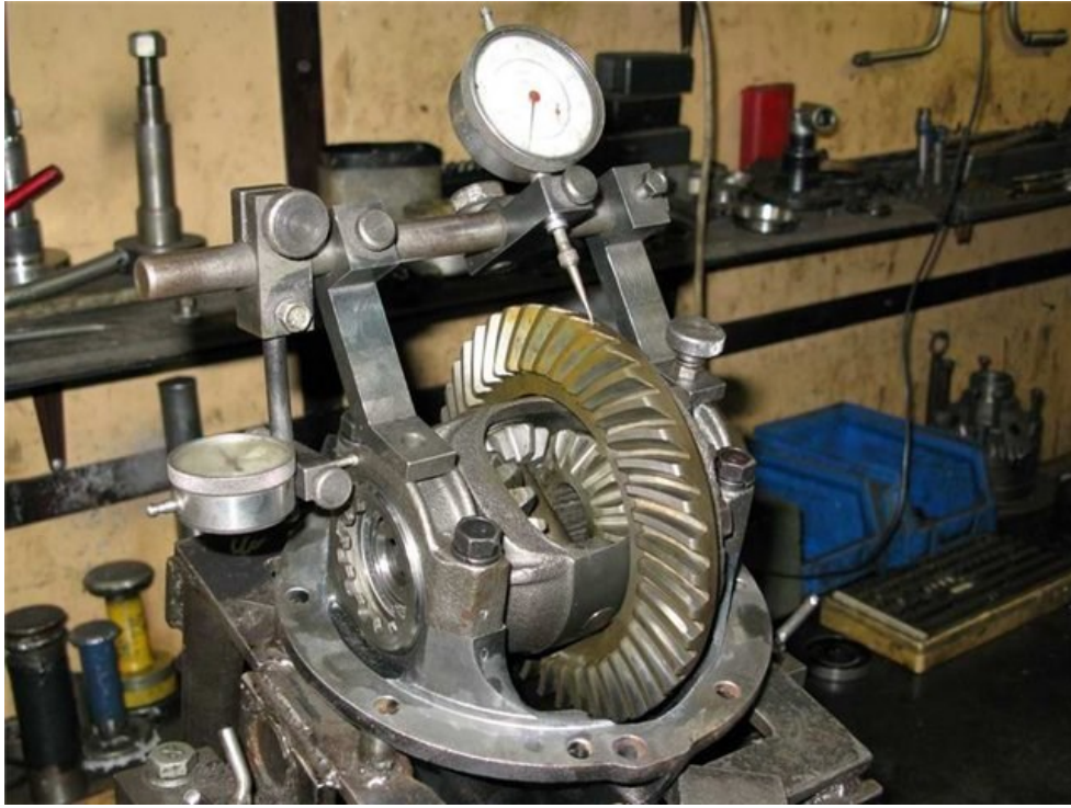
Рисунок 3.3 – Процесс регулировки редуктора заднего моста
