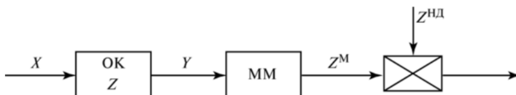
Рисунок 1.17 – Процесс оценки технического состояния
