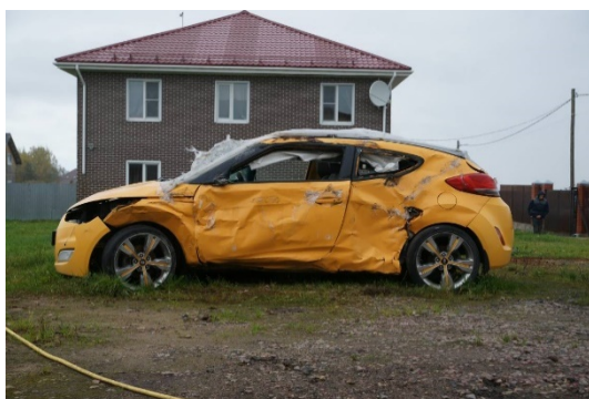
Рисунок 2.22 – а/м Hyundai Veloster с деформациями, полученными в результате ДТП
