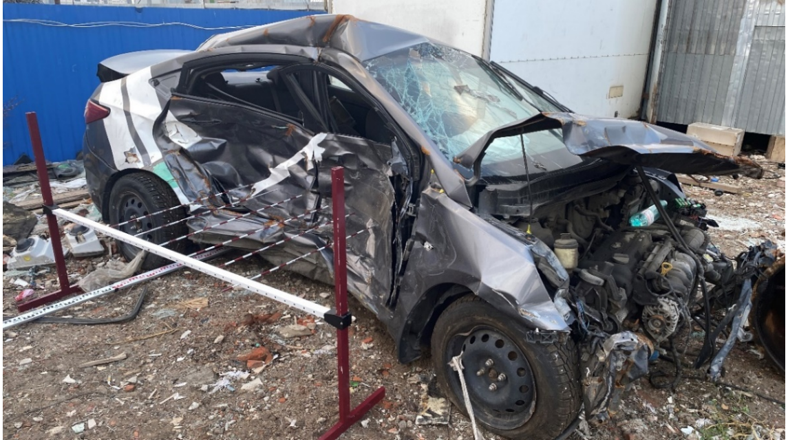
Рисунок 3.26 – Измерение глубин внедрения на высоте 500 мм от опорной поверхности
