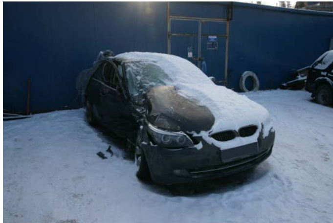
Рисунок 3.19 – Деформированный а/м BMW 530 в результате ДТП с а/м Land Rover Discovery 4
