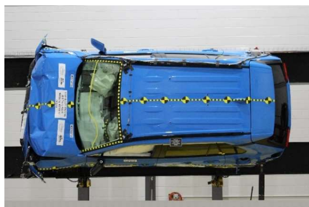
Рисунок 2.34 – Автомобиль Toyota RAV4 после проведения испытания на фронтальное столкновение
