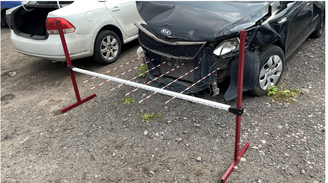
Рисунок П.В.7 – Измерение деформаций автомобиля Kia Rio
