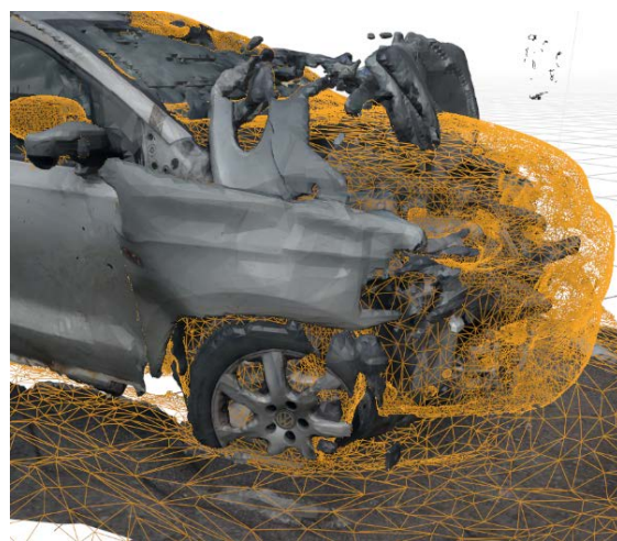
Рисунок 4.14 – Сопоставление 3D-моделей поврежденного и недеформированного состояний автомобиля Volkswagen Polo (зона разрушений)
