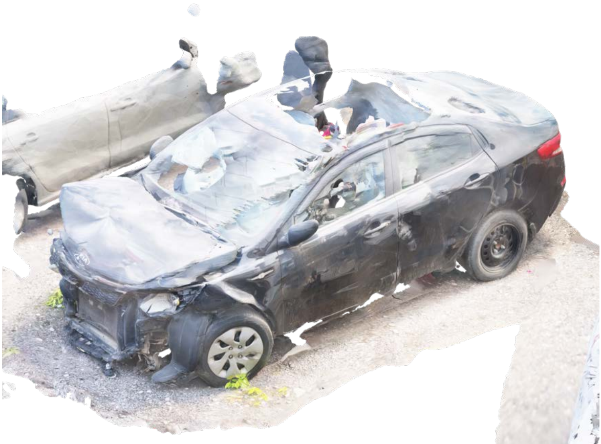
Рисунок П.В.8 – Lidar 3D-модель деформированного автомобиля Kia Rio
