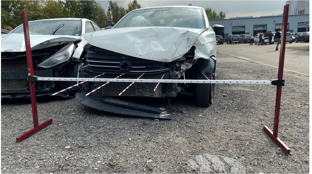
Рисунок П.В.5 – Измерение деформаций автомобиля Volkswagen Polo
