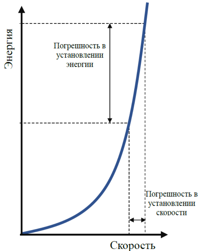
Рисунок 2.5 – Зависимость погрешности в установлении скорости, в зависимости от погрешности установления энергии
