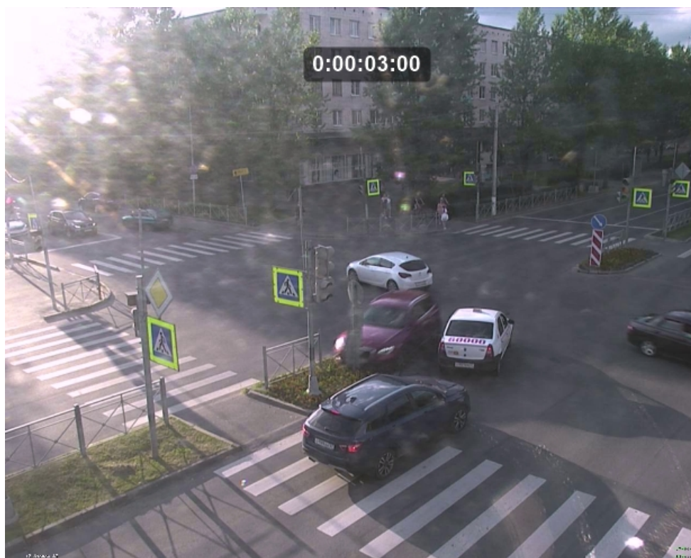
Рисунок 3.4 – Момент включения желтого сигнала светофора – в ПО Kinovea v.0.8.27 по таймеру на 0:00:03:00 (с момента включения зеленого мигающего сигнала светофора)
