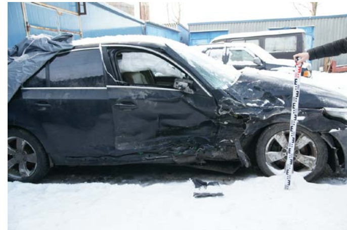
Рисунок 3.20 – Деформированный а/м BMW 530 в результате ДТП с а/м Land Rover Discovery 4
