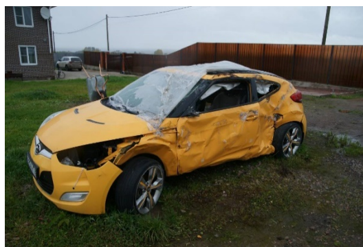
Рисунок 2.23 – а/м Hyundai Veloster с деформациями, полученными в результате ДТП
