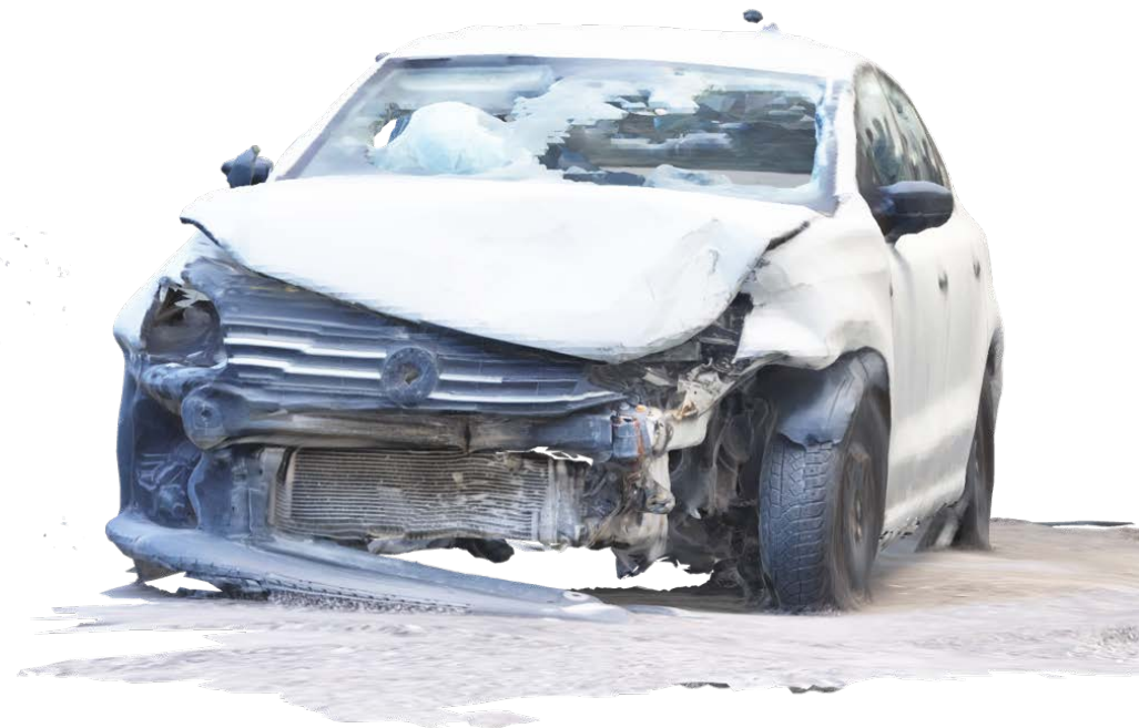
Рисунок П.В.6 – Lidar 3D-модель деформированного автомобиля Volkswagen Polo
