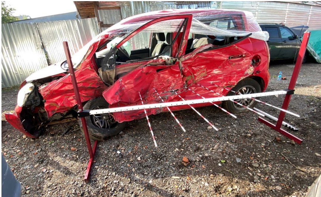
Рисунок П.В.1 – Измерение деформаций автомобиля Kia Picanto
