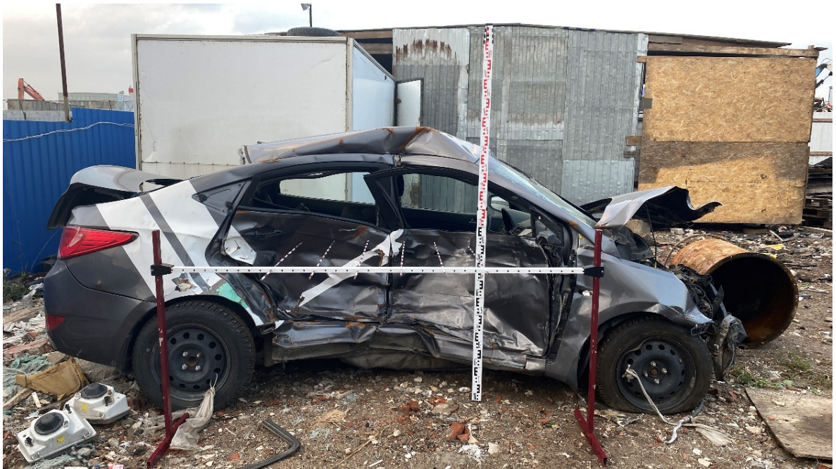
Рисунок 3.27 – Измерение глубин внедрения на высоте 860 мм от опорной поверхности
