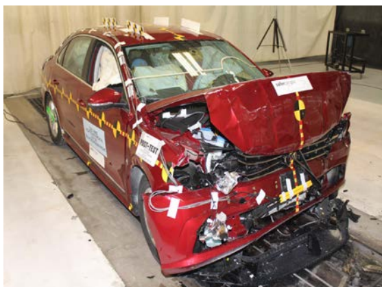
Рисунок 2.6 – Автомобиль Volkswagen Passat, получивший в результате КСВ деформации по всей ширине передней части кузова
