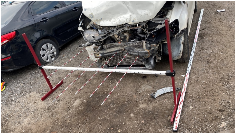
Рисунок 4.10 – Измерение глубин внедрения на высоте 490 мм от опорной поверхности
