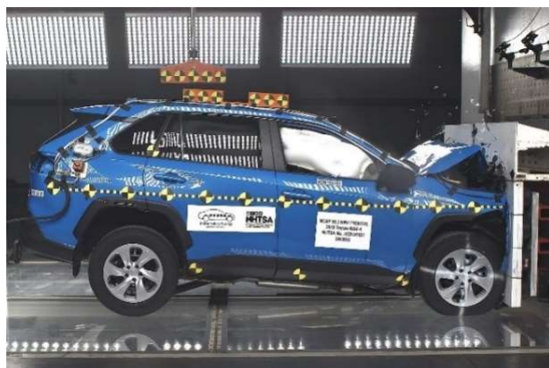
Рисунок 2.31 – Автомобиль Toyota RAV4 в момент кульминации испытания на фронтальное столкновение
