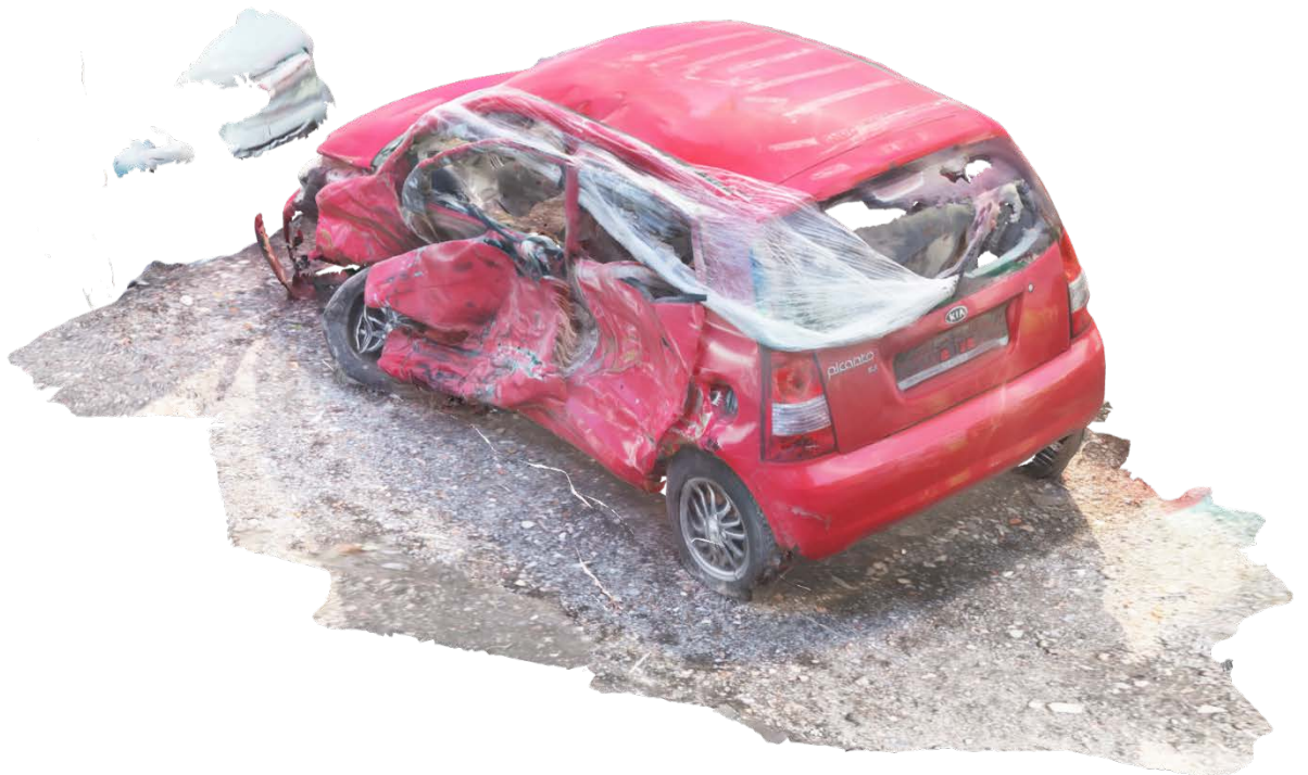
Рисунок П.В.4 – Lidar 3D-модель деформированного автомобиля Kia Picanto
