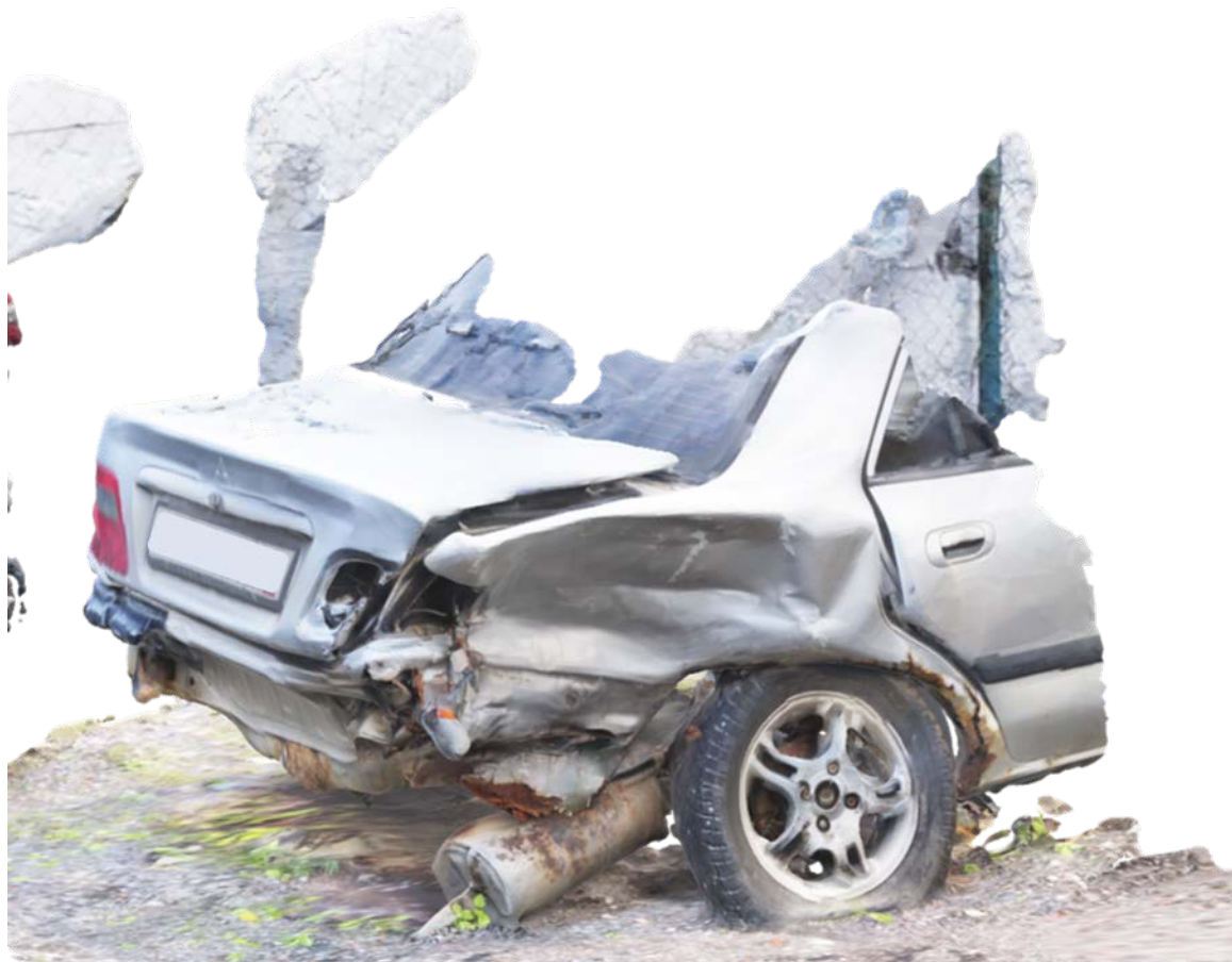
Рисунок П.В.12 – Lidar 3D-модель деформированной задней части автомобиля Mitsubishi Carisma
