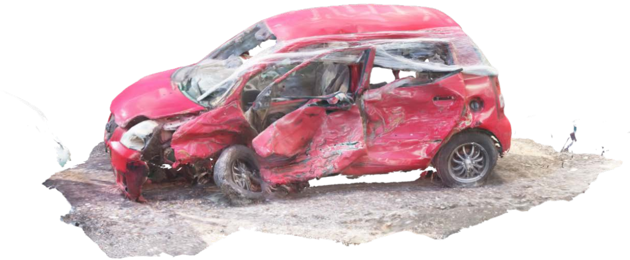
Рисунок П.В.3 – Lidar 3D-модель деформированного автомобиля Kia Picanto
