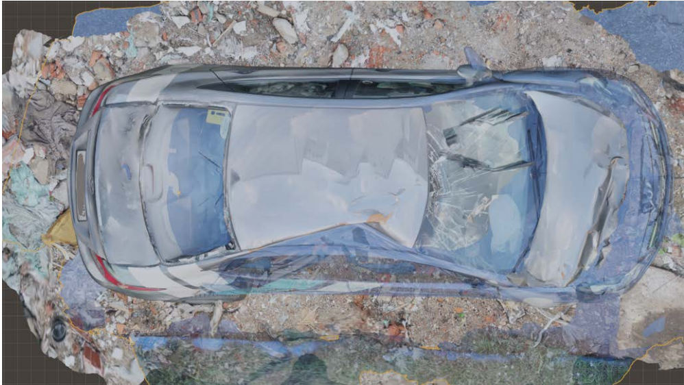
Рисунок 3.32 – Результат совмещения 3D-моделей деформированного и недеформированного состояния автомобиля Hyundai Solaris
