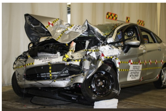
Рисунок 2.8 – Автомобиль Ford Fiesta, участвующий в краш-тесте с 35% перекрытием (деформирующие силы были приложены только к 35% фронтальной части)
