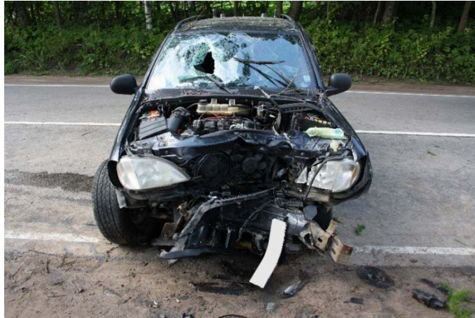
Рисунок 3.17 – Объем полученных деформаций а/м Mercedes-Benz ML320 при наезде на дерево
