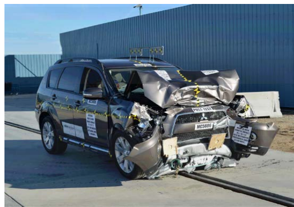
Рисунок 2.7 – Автомобиль Mitsubishi Outlander, получивший в результате КСВ деформации по всей ширине передней части кузова
