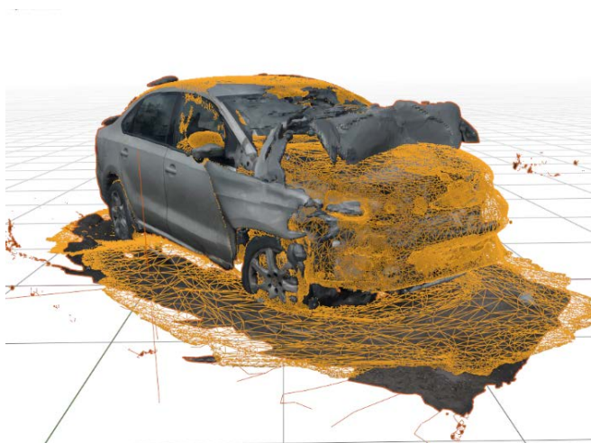
Рисунок 4.13 – Сопоставление 3D-моделей поврежденного и недеформированного состояний автомобиля Volkswagen Polo (общий вид)
