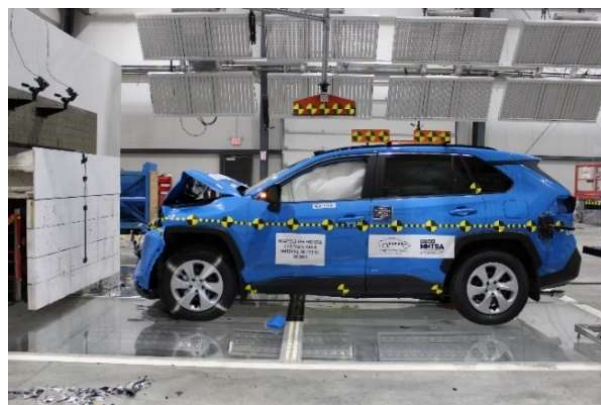
Рисунок 2.32 – Автомобиль Toyota RAV4 после проведения испытания на фронтальное столкновение
