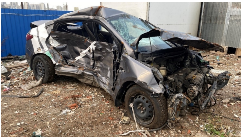
Рисунок 3.25 – Автомобиль Hyundai Solaris, получивший объемные фронтальные и боковые деформации в результате столкновения
