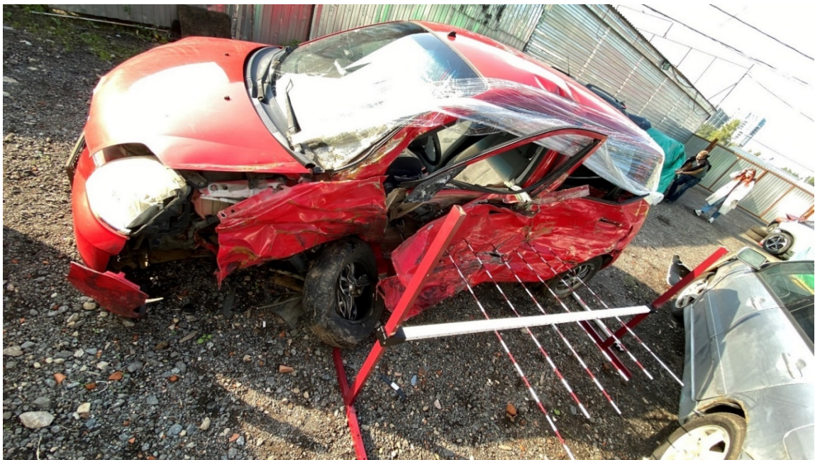
Рисунок П.В.2 – Измерение деформаций автомобиля Kia Picanto
