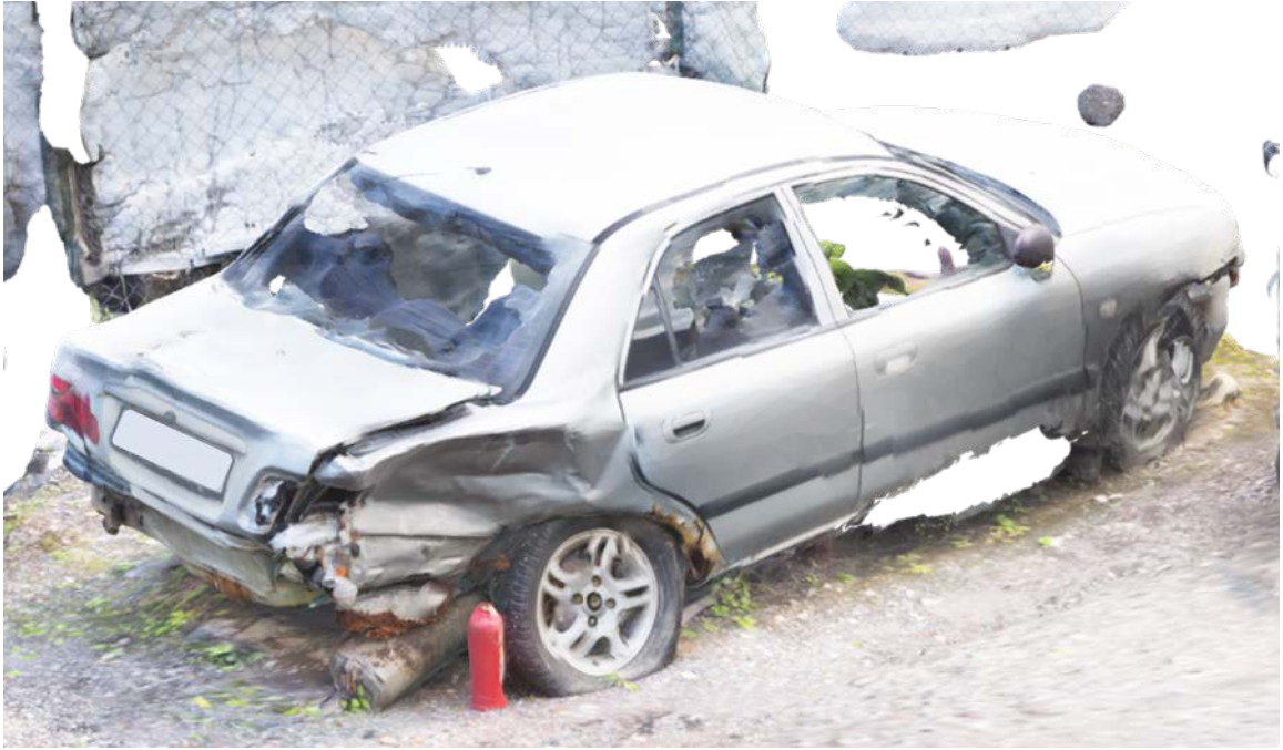
Рисунок П.В.11 – Lidar 3D-модель деформированного автомобиля Mitsubishi Carisma
