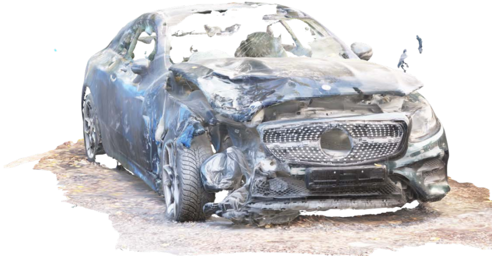
Рисунок П.В.9 – Lidar 3D-модель деформированного автомобиля Mercedes-Benz E class
