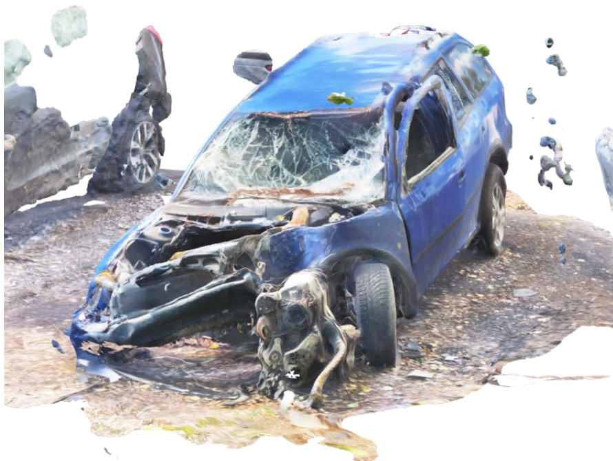
Рисунок П.В.14 – Lidar 3D-модель деформированного автомобиля Skoda Octavia
