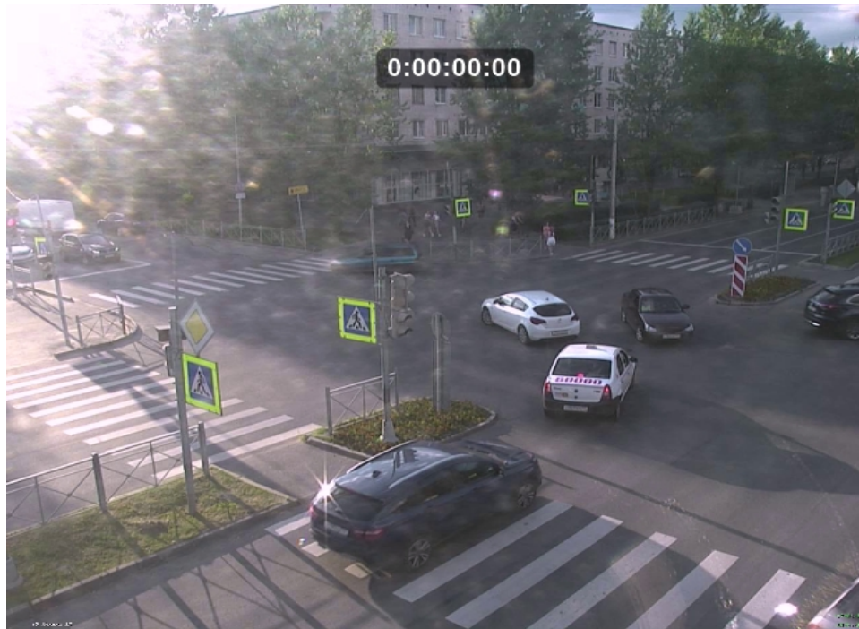
Рисунок 3.2 – Момент включения зеленого мигающего сигнала светофора – в ПО Kinovea v.0.8.27 установлен таймер на 0:00:00:00)
