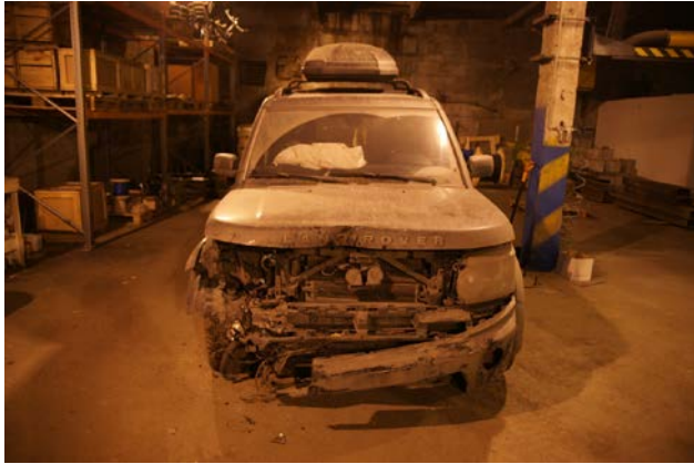
Рисунок 3.21 – Деформированный а/м Land Rover Discovery 4 в результате ДТП с а/м BMW 530
