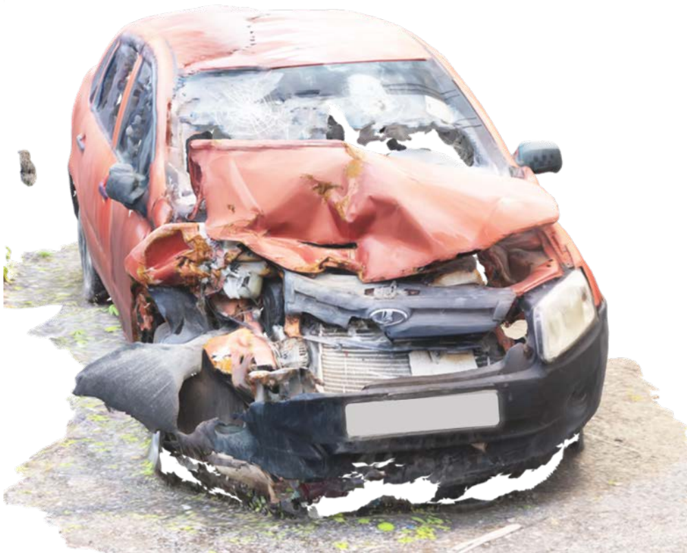
Рисунок П.В.10 – Lidar 3D-модель деформированного автомобиля Lada Granta
