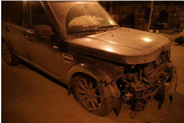
Рисунок 3.22 – Деформированный а/м Land Rover Discovery 4 в результате ДТП с а/м BMW 530
