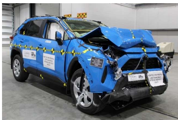
Рисунок 2.33 – Автомобиль Toyota RAV4 после проведения испытания на фронтальное столкновение
