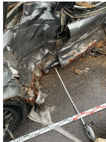
Рисунок 3.15 – Измерение деформаций а/м BMW 520
