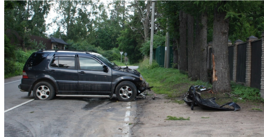
Рисунок 3.18 – Объем полученных деформаций а/м Mercedes-Benz ML320 при наезде на дерево
