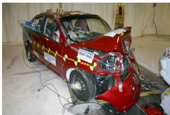
Рисунок 2.9 – Автомобиль Chevrolet Aveo, участвующий в краш-тесте с 50% перекрытием (деформирующие силы были приложены только к половине фронтальной части)
