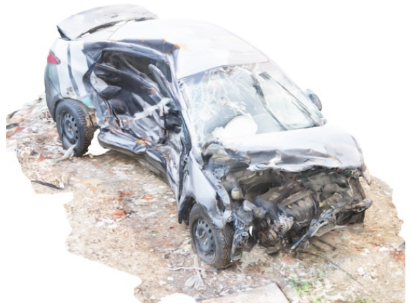
Рисунок 3.29 – 3D-модель деформированного состояния автомобиля Hyundai Solaris
