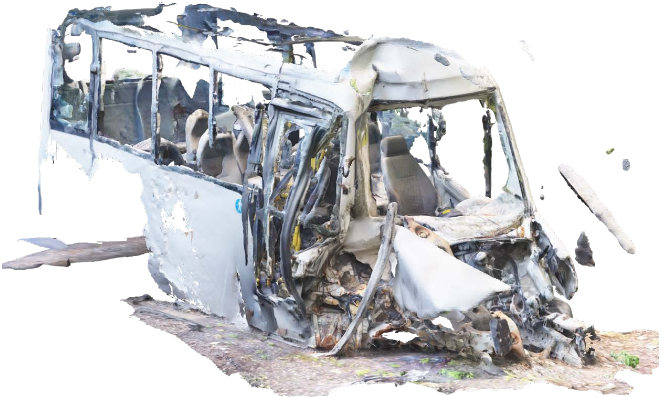
Рисунок П.В.13 – Lidar 3D-модель деформированного автомобиля ГАЗель NEXT
