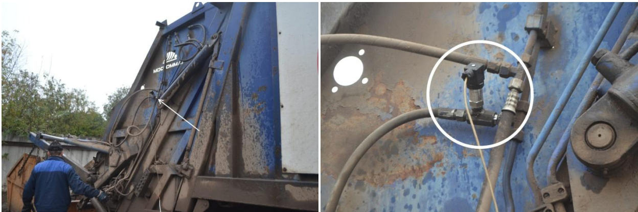
Рис. 3.3. Место установки датчика давления.
