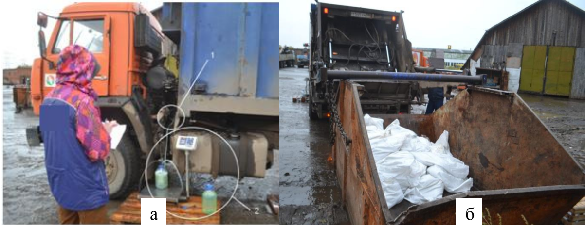
Рис. 4.1. Экспериментальные исследования на мусоровозе БМ-53229-1. а, поз. 1 – место установки трехпозиционных кранов; а, поз. 2 – место установки измерительной емкости и весов; б – процесс загрузки контейнера эталонными грузами
