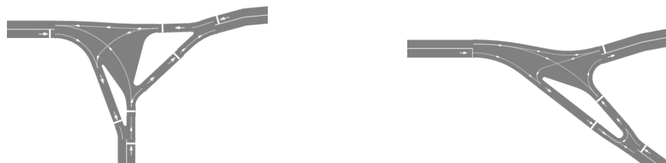
в) отделение второстепенного направления, устройство накопительной полосы для левого поворота, каплевидных и треугольных островков
