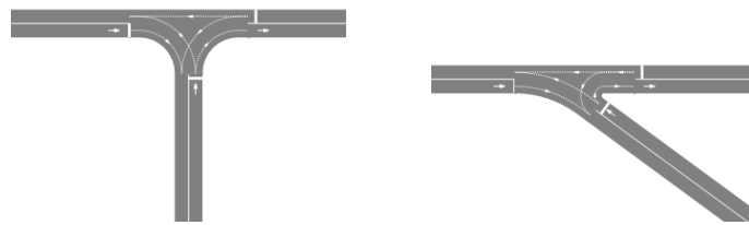
а) правильное формирование геометрии примыкания
