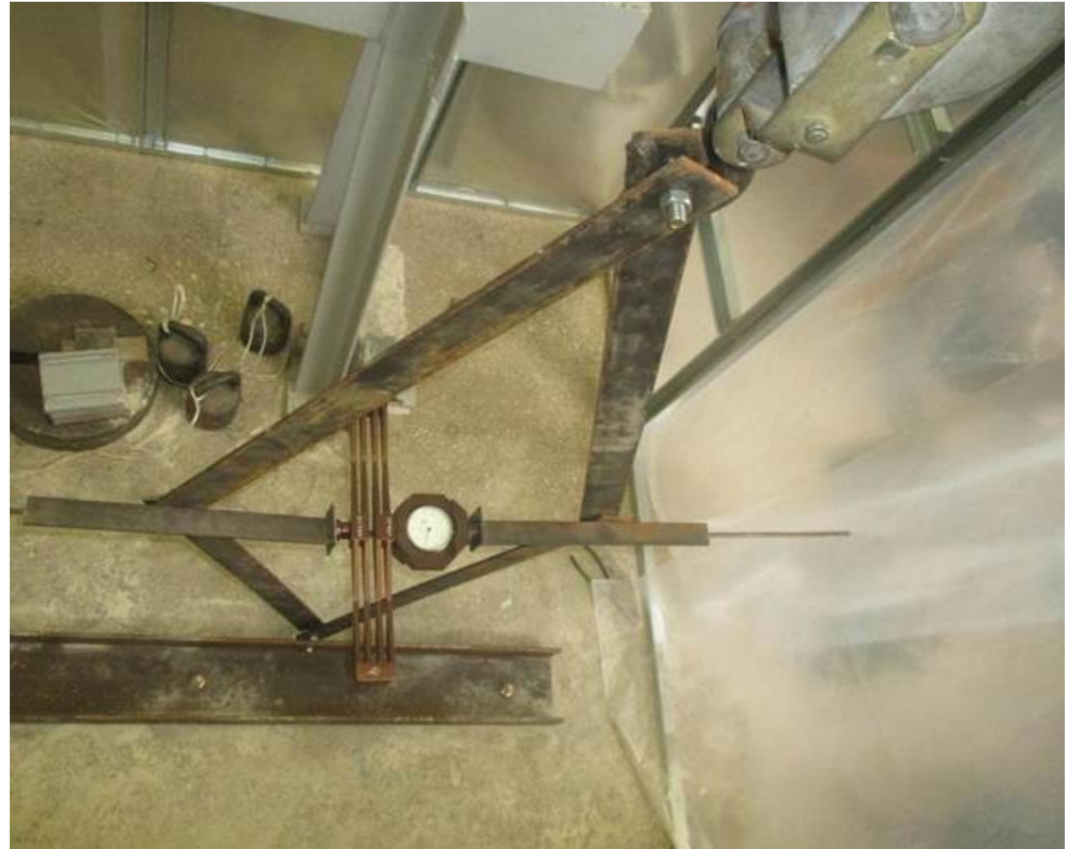
Рисунок 3.4 – Схема (а) и общий вид (б) шарнирно-стержневой системы установки для оценки прочности и устойчивости центрально сжатого стержня из древесины: 8 – исследуемый образец, 10 – силовые элементы шарнирно-стержневой системы, 11 – сжимающие элементы шарнирно-стержневой системы
