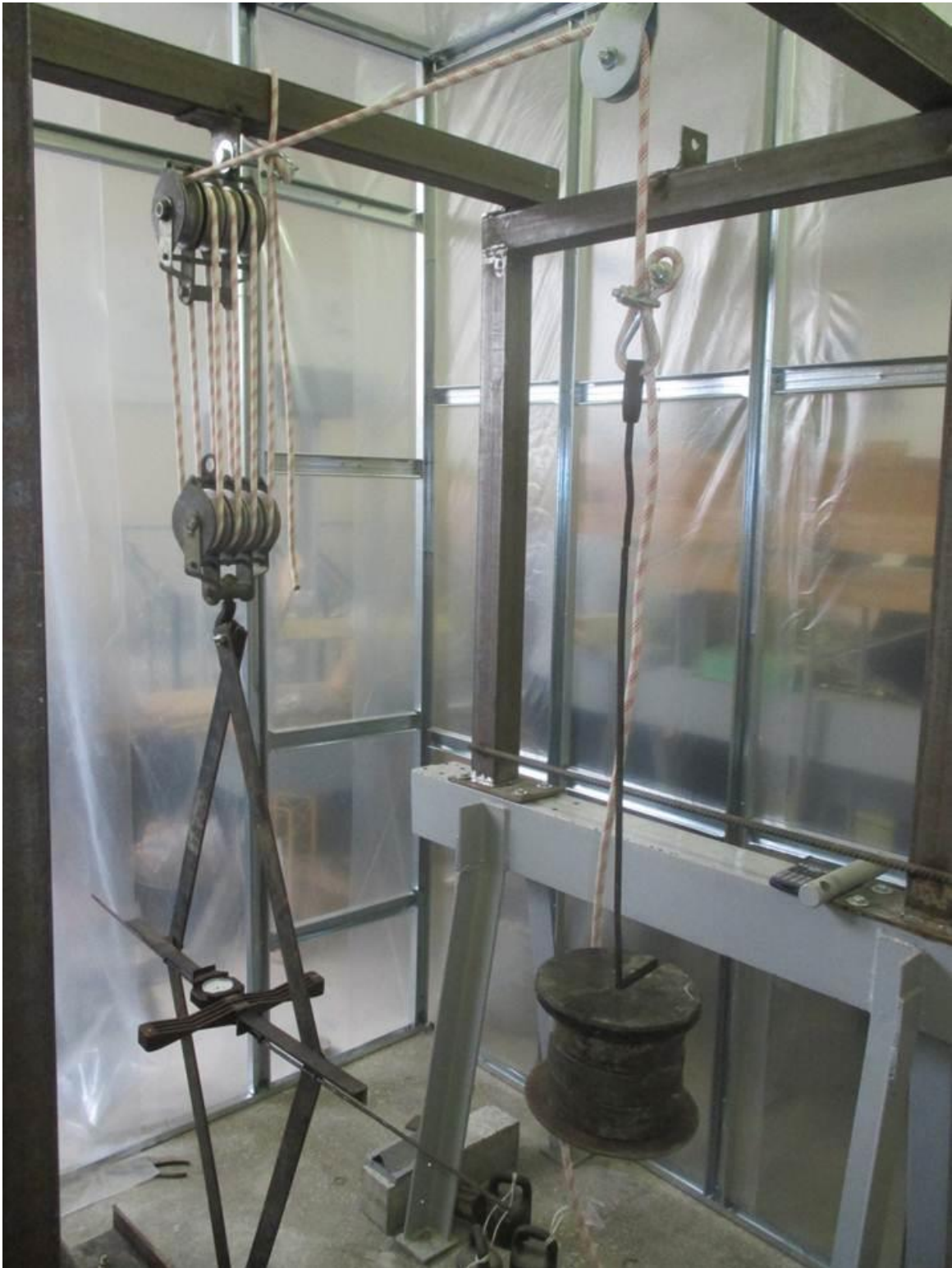
Рисунок 3.3 – Общий вид установки для оценки прочности и устойчивости центрально-сжатого стержня из древесины
