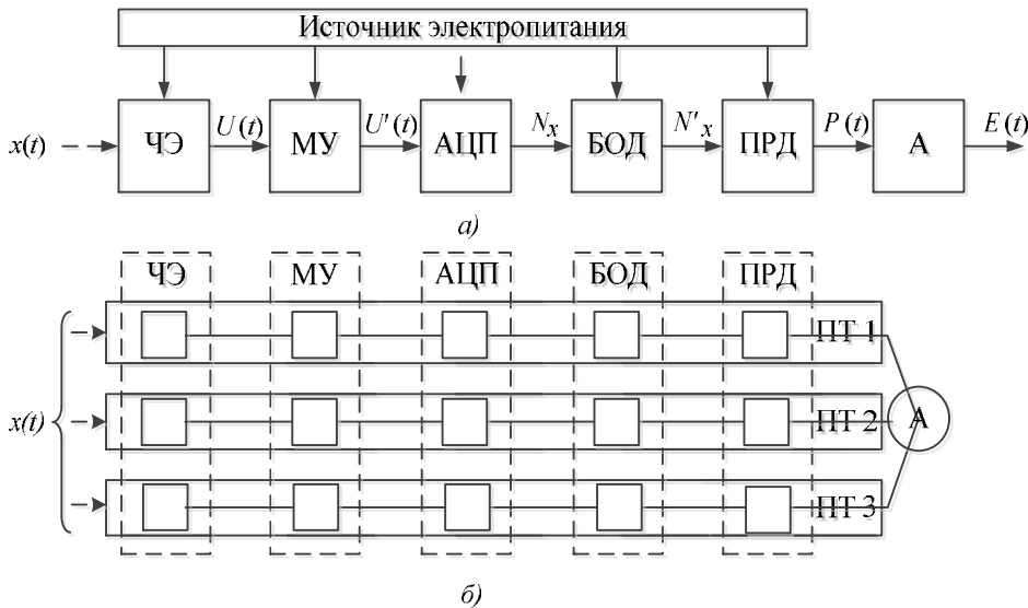
Рисунок 1 – Обобщенные структурные схемы БЭД (а) и комбинированного (совмещенного) БЭД (б)
