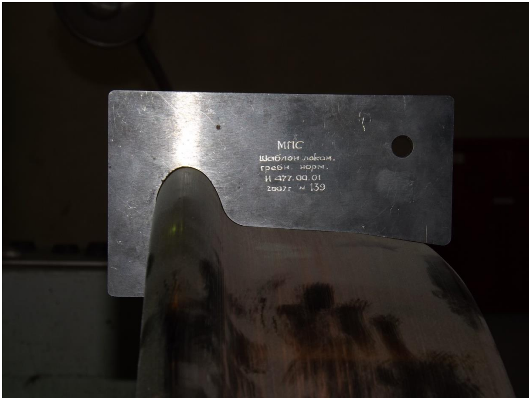
Рисунок 4.4. Оценка точности профиля колеса с использованием специального шаблона по ГОСТ 10791-2011
