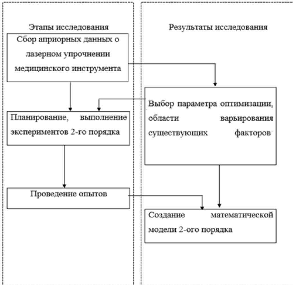
Рисунок 3.1 — Этапы разработки плана эксперимента, связанного с оптимизацией режимов лазерной импульсной обработки режущего инструмента медицинского назначения
