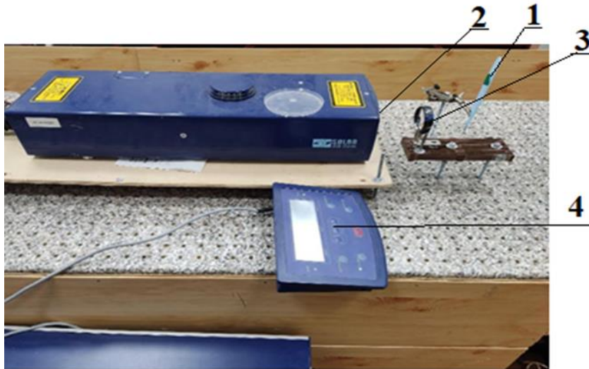
Рисунок 2.3 — Общий вид устройства упрочнения скальпеля импульсным лазером: 1 — скальпель, 2 — импульсный лазер, 3 — линза, 4 — пульт управления.
