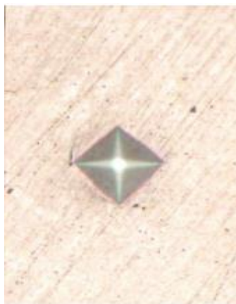
Рисунок 3.10 — Характеристика слоя стали 40Х13 образца №7 по отпечаткам алмазной пирамиды на медицинском инструменте
