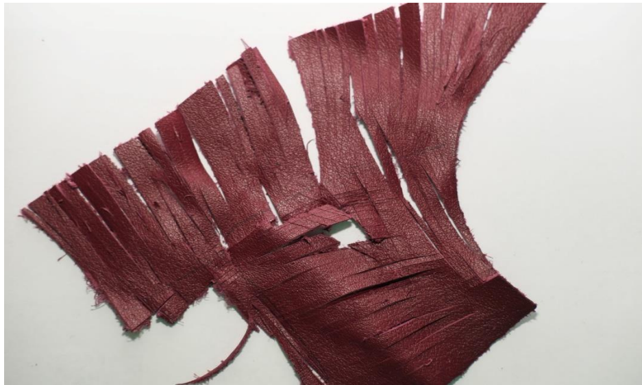
Рисунок 3.13– Образец нарезки кожи режущей кромкой скальпеля после ЛУ, режим №2: E = 0,15 Дж, \tau=10 нс, f=20 Гц
