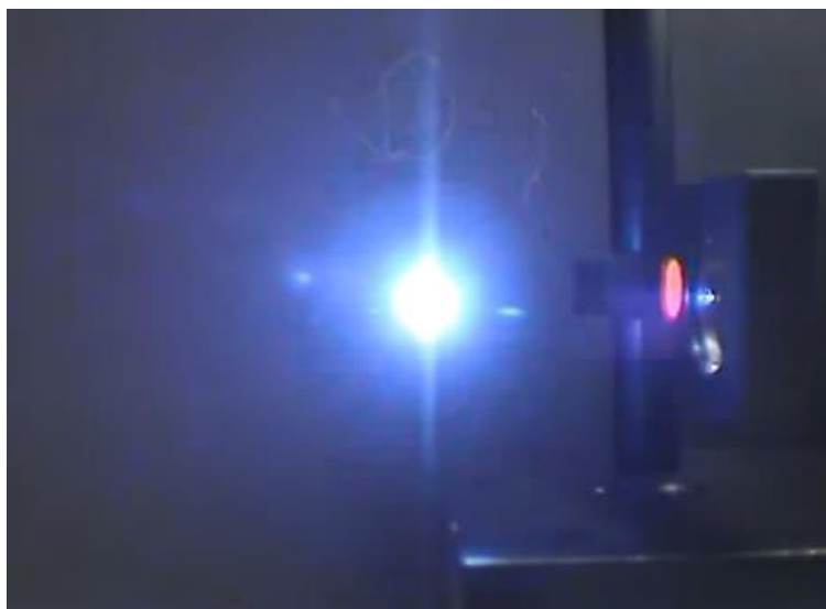
Рисунок 2.5 — Оптический разряд в фокусе короткофокусной менисковой линзы с f = 25 мм
