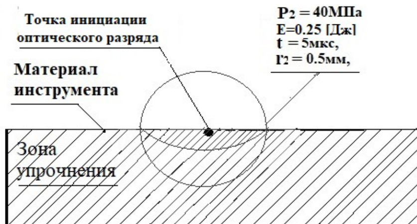
Рисунок 4.9 — Схема упрочнения поверхности скальпеля лазерным импульсным оптическим наносекундным разрядом
